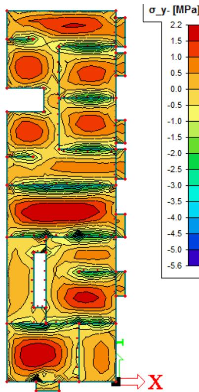
**Crtež 7.9.** Tlačna naprezanja u betonu na donjoj plohi ploče  $\sigma_{c,y,-}$  [MPa] u smjeru Y za nazovistalnu kombinaciju GSU-2:  $1,0*(G_0+G) + 0,3Q$
