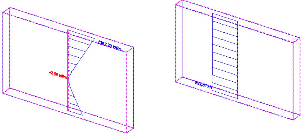
**Crtež 7.26.** Unutarnje sile u zidu u osi 10x / E-F
