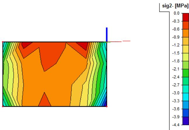
**Crtež 7.25.** Naprezanja u zidu  $\sigma_c, GSU-2: 1,0*(G_0+G) + 0,3Q$
