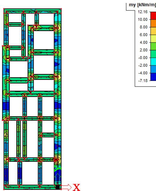
**Crtež 7.40.** Potrebna armatura [ $\text{cm}^2/\text{m}$ ] u Y smjeru
