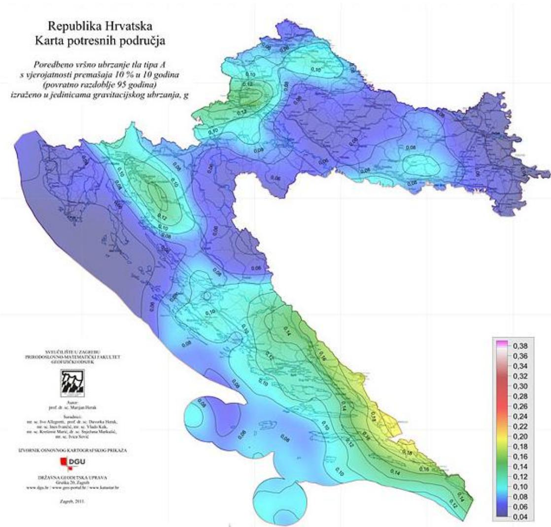
**Crtež 4.4.** Karta potresnih područja Hrvatske za poredbeno vršna ubrzanja temeljnog tla  $a_{gr}$  za temeljno tlo tipa A, za poredbeno povratno razdoblje potresa  $T_{NCR} = 95$  godina
