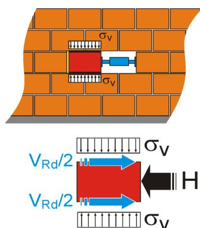
**Crtež 2.5.** Ispitivanje posmične čvrstoće ziđa – in situ
