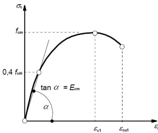
**Crtež 3.3.** Radni dijagram betona
