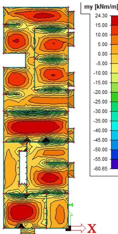
**Crtež 7.5.** Prikaz momenata savijanja  $m_y$  [ $\text{kNm}/\text{m}$ ] na pločama za osnovnu kombinaciju
