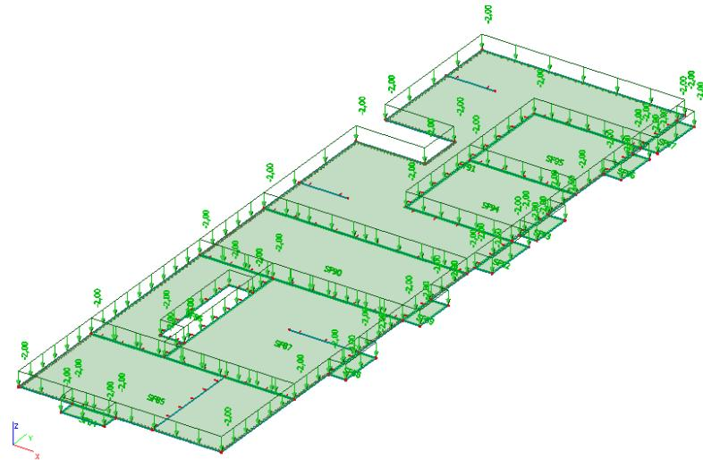
**Crtež 7.2.** Dodatno stalno opterećenje  $G$  [ $\text{kN}/\text{m}^2$ ]
