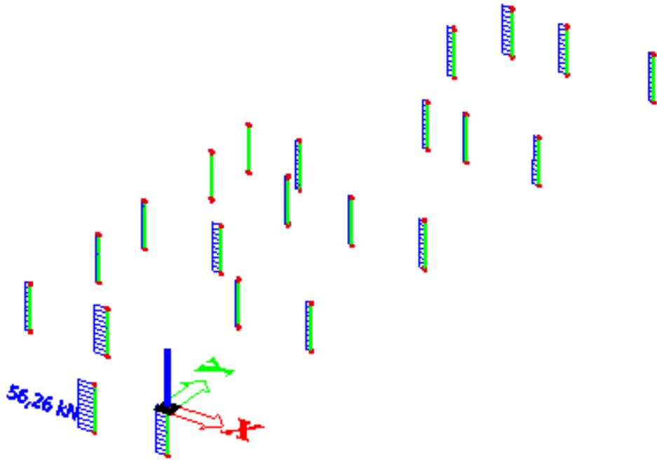
**Crtež 7.32.** Poprečne sile  $V_{Sd,z}[\text{kN}]$  na stupovima za anvelopu potresnog djelovanja
