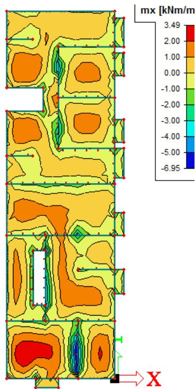
Crtež 7.10. Potrebna armatura [ $\text{cm}^2/\text{m}$ ] u X smjeru
