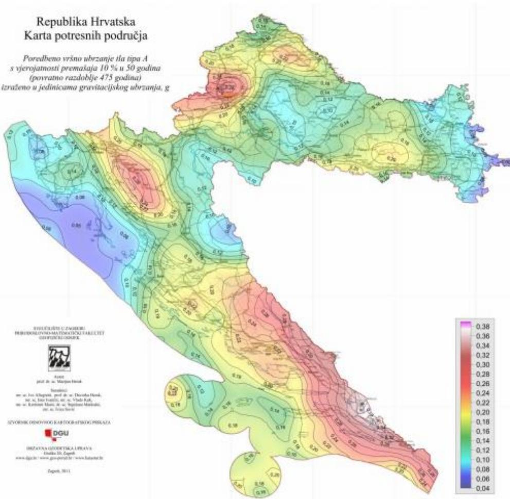
**Crtež 4.4.** Karta potresnih područja Hrvatske za poredbena vršna ubrzanja temeljnog tla  $a_{gr}$  za temeljno tlo tipa A, za poredbeno povratno razdoblje potresa  $T_{NCR} = 475$  godina
