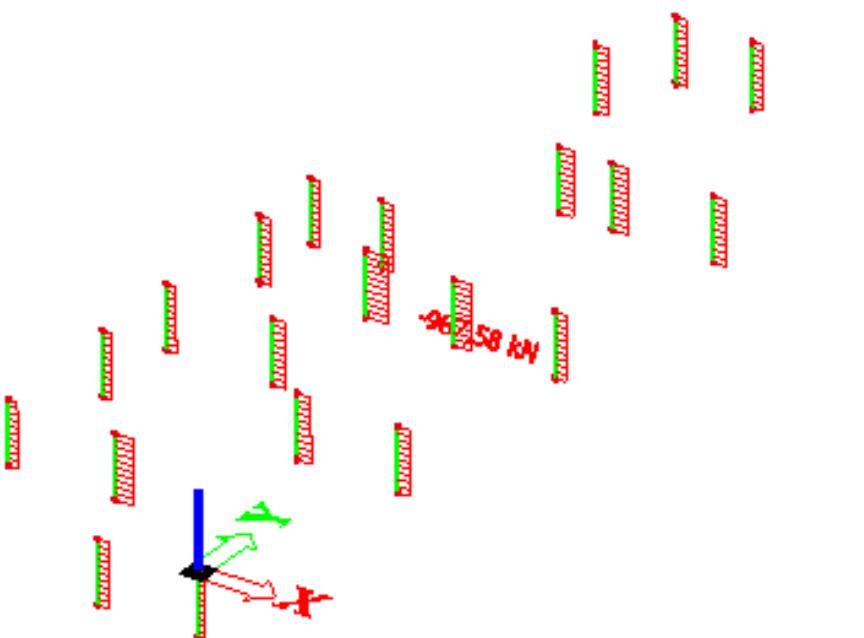
**Crtež 7.31.** Uzdužne sile  $N_{Sd}$  [kN] na stupovima za anvelopu potresnog djelovanja
