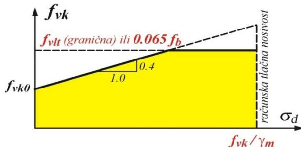
**Crtež 2.6.** Ovisnost posmične čvrstoće i tlačnog naprezanja
