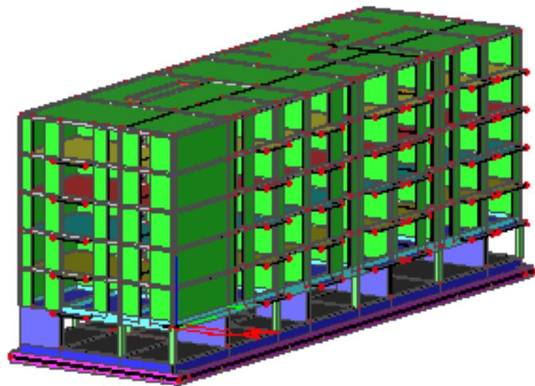
**Crtež 7.33.** Model konstrukcije s armirano-betonskim prizemljem
