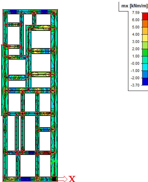
**Crtež 7.39.** Potrebna armatura [ $\text{cm}^2/\text{m}$ ] u X smjeru
