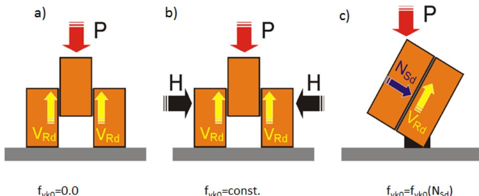
**Crtež 2.4.** Ispitivanje posmične čvrstoće ziđa
