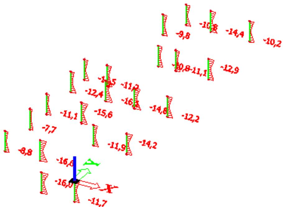
**Crtež 7.29.** Naprezanja u stupovima  $\sigma_{c,max}$  [MPa] za anvelopu potresnog djelovanja
