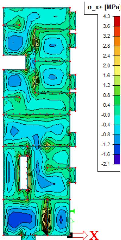
**Crtež 7.6.** Tlačna naprezanja u betonu na gornjoj plohi ploče  $\sigma_{c,x,+}$  [MPa] u smjeru X za nazovistalnu kombinaciju GSU-2:  $1,0*(G_0+G) + 0,3Q$
