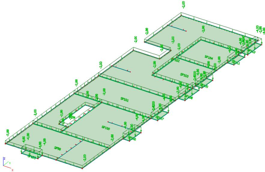
**Crtež 7.3.** Uporabno opterećenje  $Q$  [ $\text{kN}/\text{m}^2$ ]
