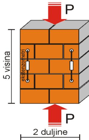
**Crtež 2.3.** Ispitivanje tlačne čvrstoće ziđa
