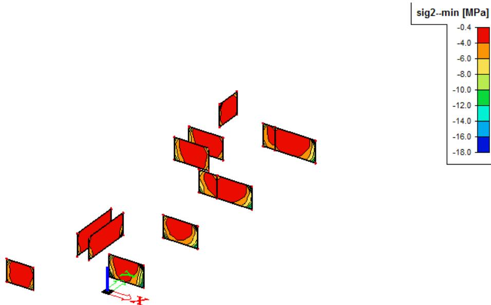
**Crtež 7.24.** Naprezanja u zidu  $\sigma_{c,Rd}$ , ANV 10-13
