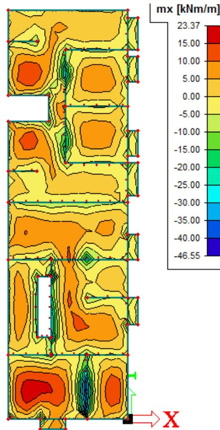
**Crtež 7.4.** Prikaz momenata savijanja  $m_x$  [ $\text{kNm}/\text{m}$ ] na pločama za osnovnu kombinaciju
