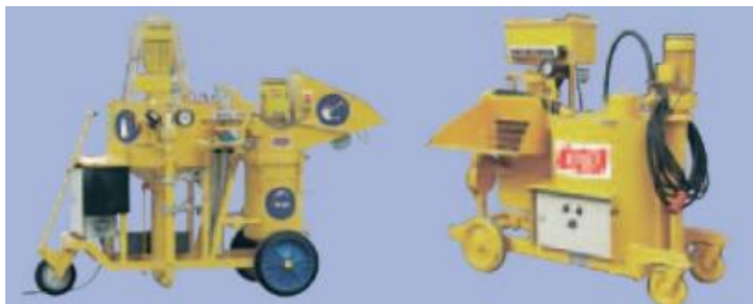
Slika 2.12 Oprema za injektiranje [11]
