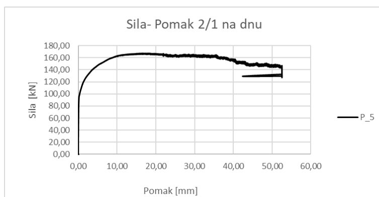
Slika 4.26 Odnos sile izvlačenja i pomaka 2/1 mjenog pomoću LVDT na dnu
