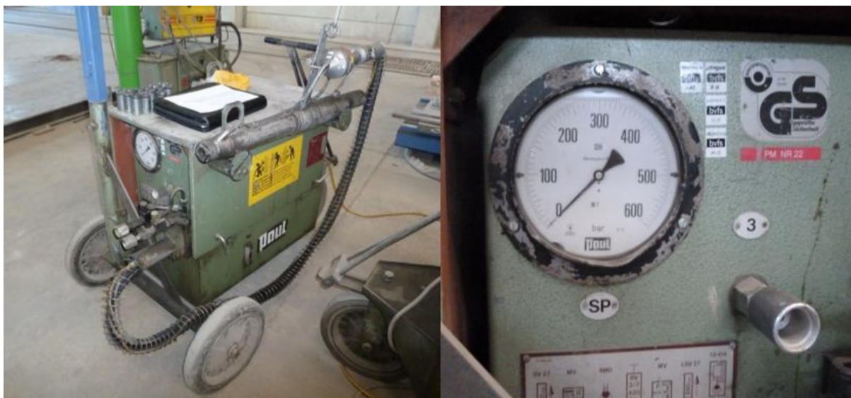
Slika 4.6. Hidraulički uređaj za prednapinjanje
