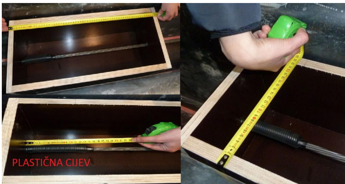
Slika 4.8 Plastična cijev te dimenzije kalupa
