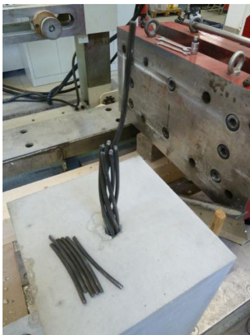
Slika 4.21 Izgled užeta nakon pojedinih testova
