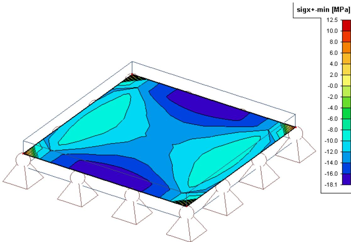
Slika 7.17. Prikaz stanja naprezanja na elementu  $1 \times 1$  m,  $\sigma_x^+$  (gornja strana neutralne osi)
