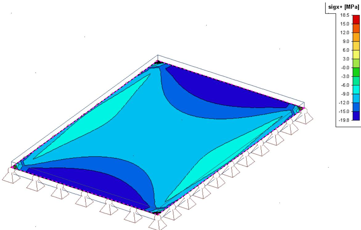
Slika 7.15. Prikaz stanja naprezanja na elementu  $3 \times 2\text{ m}$ ,  $\sigma_x^+$  (gornja strana neutralne osi)
