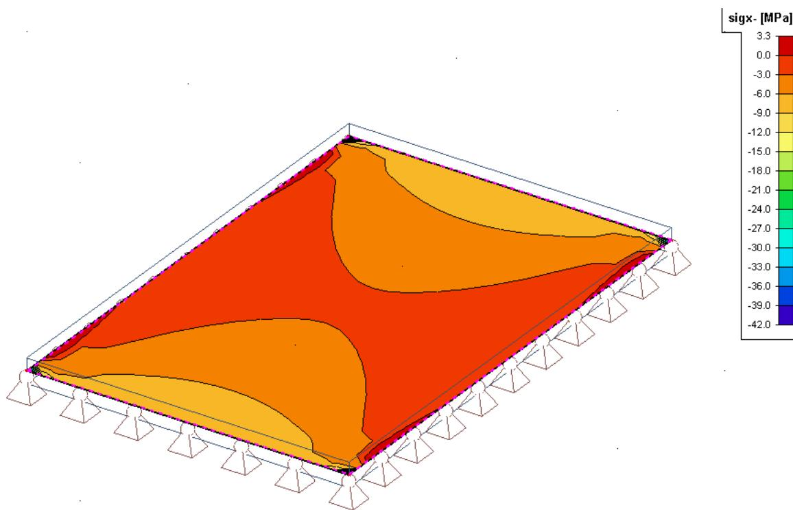
Slika 7.14. Prikaz stanja naprezanja na elementu  $3 \times 2\text{ m}$ ,  $\sigma_x^-$  (donja strana neutralne osi)
