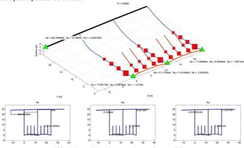
▲ Slika 6. Geometrija sidrenog sustava zadana modelom
