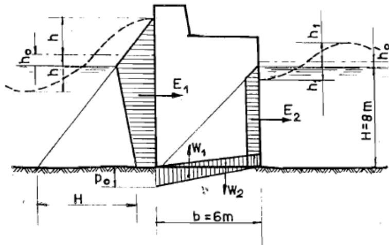
Slika 4.2. Shema hidrodinamičkog opterećenja
