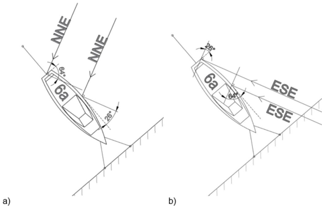
Slika 3. Shema projekcija sila iz smjera NNE (a) i iz smjera ESE (b) u odnosu na položaj broda
