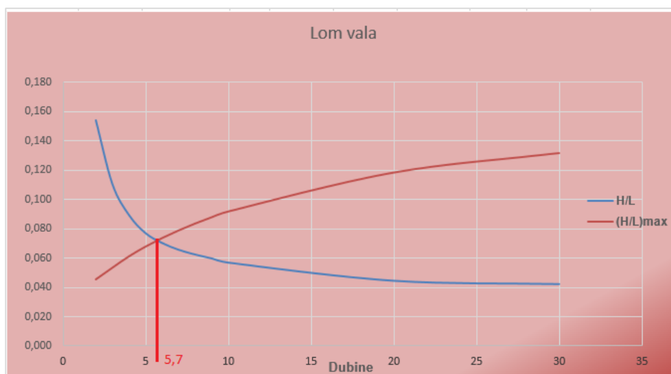
Slika 3.6. Mjesto loma vala
