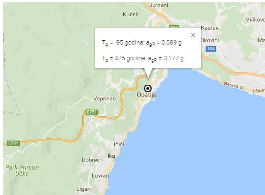
Slika 3. Prikaz horizontalnog potresnog ubrzanja tla za područje grada Opatije ( www.seizkarta.gfz.hr )
