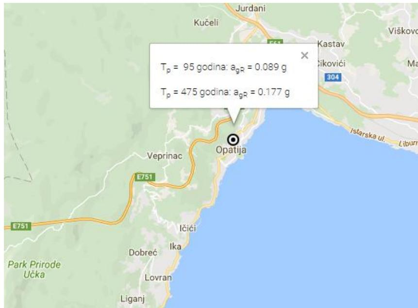
Slika 3. Prikaz horizontalnog potresnog ubrzanja tla za područje grada Opatije
