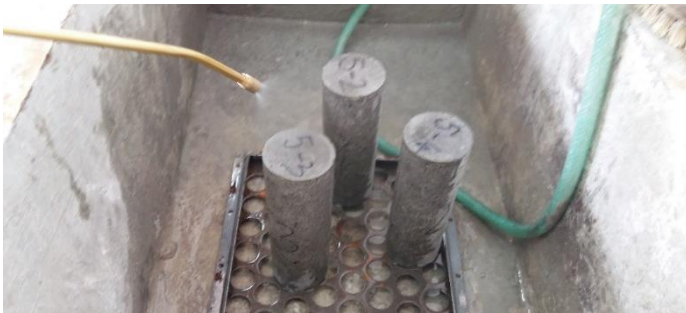
Slika 6.2. a) Hlađenje uzorka vodom; b) vrijednost tlaka u pumpi [slike zabilježene tijekom ispitivanja]
