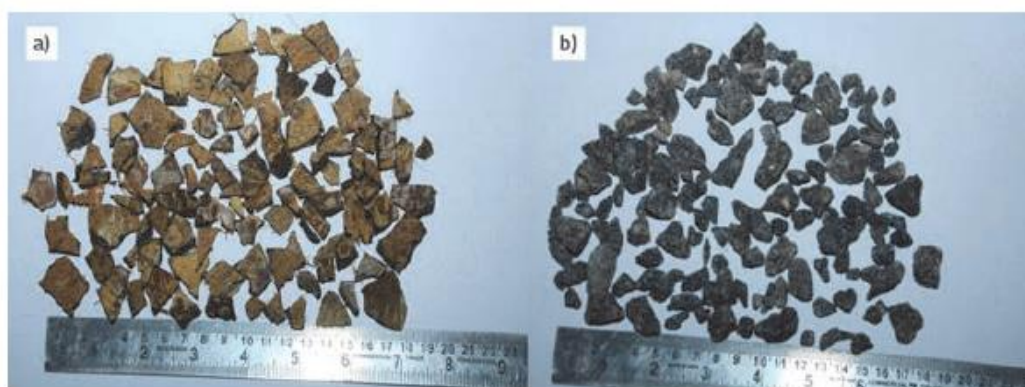
Slika 4.2. Krupni agregati: a) agregat od kokosovih ljuski; b) agregat od granita [14]
