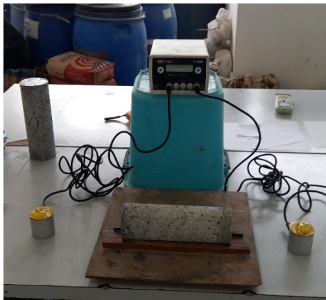
Slika 6.17. Uređaj za mjerenje brzine ultrazvučnih valova [slika zabilježena tijekom ispitivanja]
