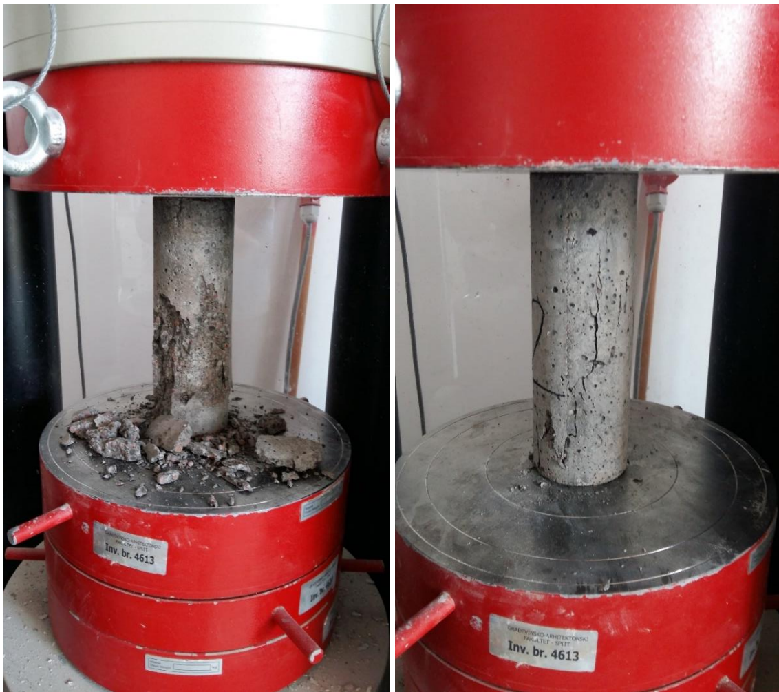
Slika 6.7. Ispitivanje tlačne čvrstoće uzoraka mješavine SCC6 [slike zabilježene tijekom ispitivanja]
