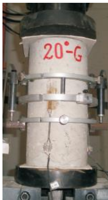
Slika 4.14. a) Uređaj za ispitivanje čvrstoće na savijanje; b) Uređaj za mjerenje modula elastičnosti [15]
