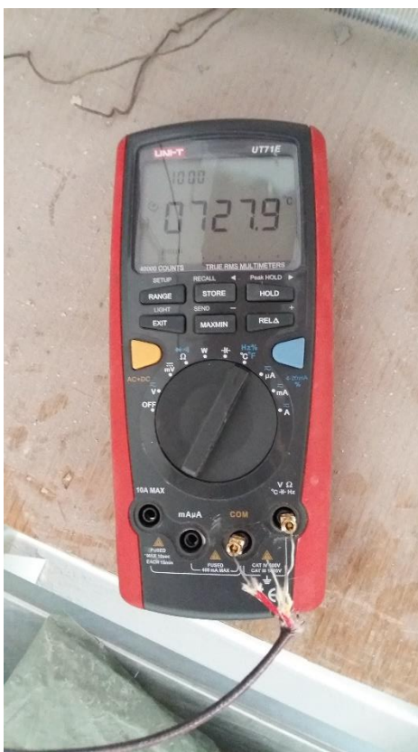
Slika 6.29. Temperatura unutar strukture uzorka 24 mješavine SCC7
