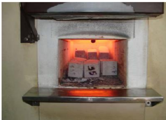
Slika 4.20. Uzorci u električnoj peći [16]
