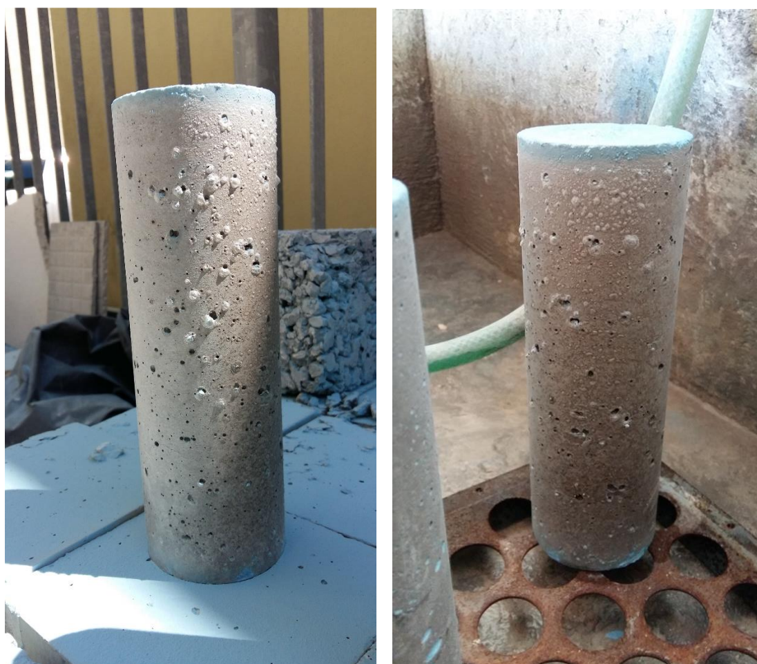
Slika 6.30. Površinska reakcija uzoraka nakon izlaganja prahu vatrogasnog aparata
