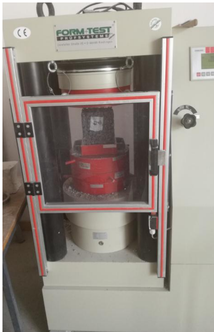
Slika 4.11 Ispitivanje tlačne čvrstoće hidrauličkom prešom
