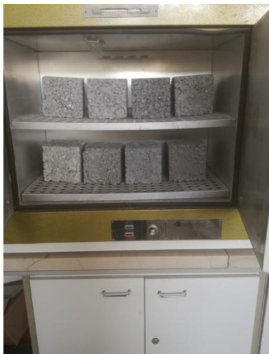
Slika 4.8 Sušenje uzoraka u pećnici
