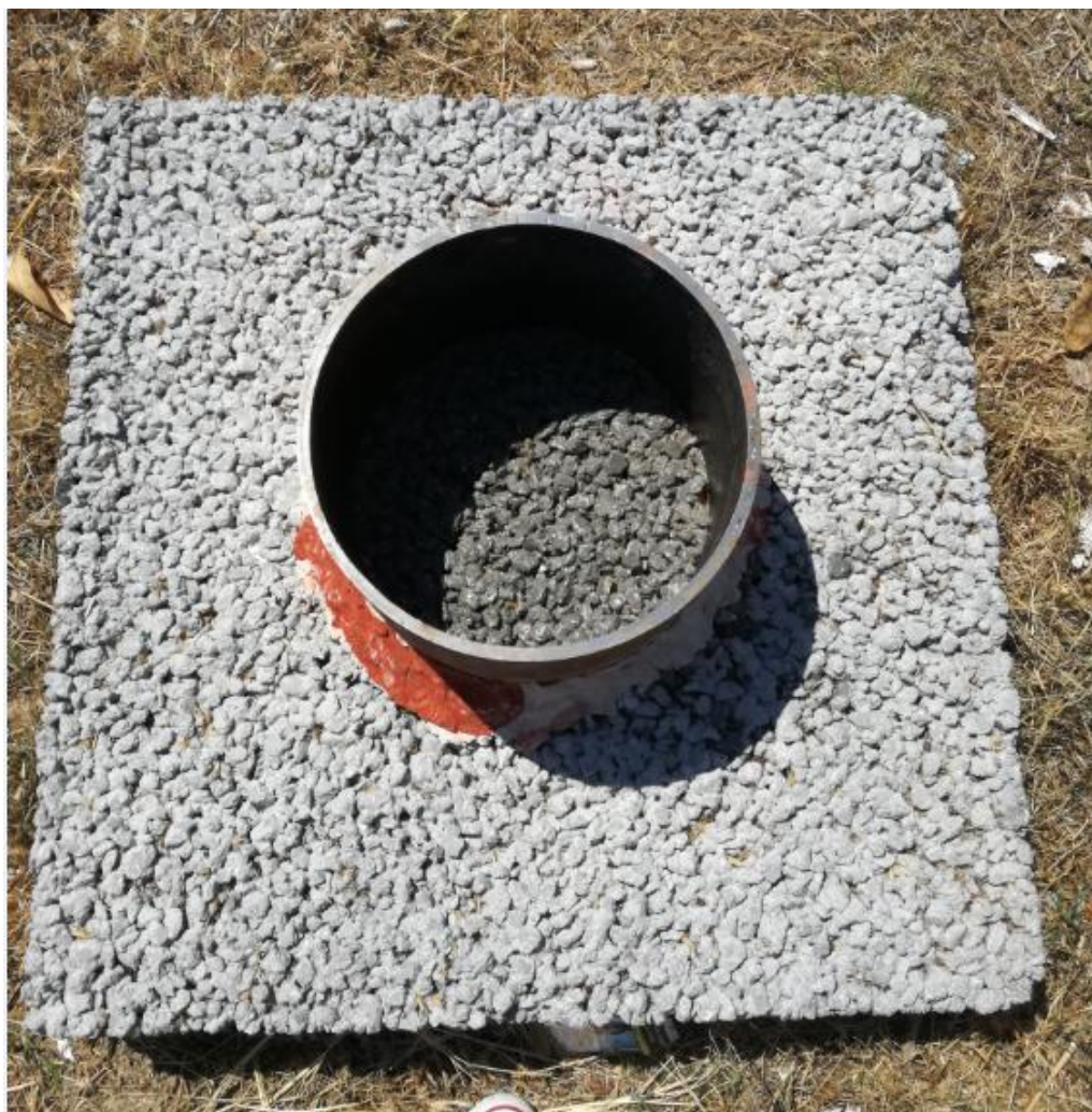
Slika 4.18 Čelični prsten postavljen na porozno – betonsku ploču
