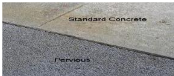
Slika 3.1 Usporedba poroznog i običnog betona [17]
