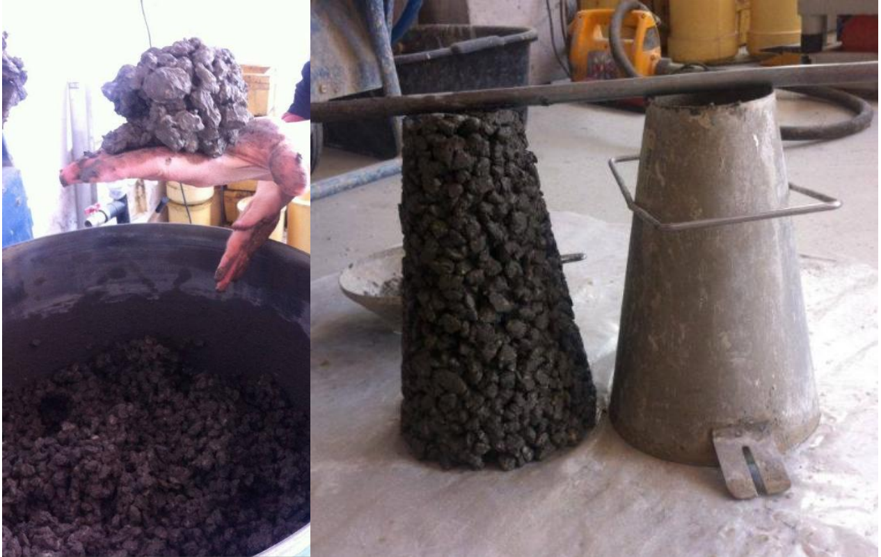
Slika 5.3 Ispitivanje konzistencije mješavine P 3
