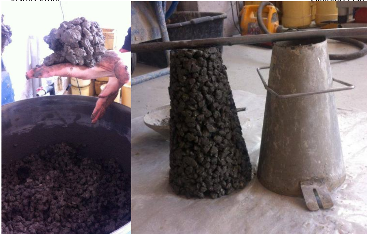
Slika 5.3 Ispitivanje konzistencije mješavine P 3
