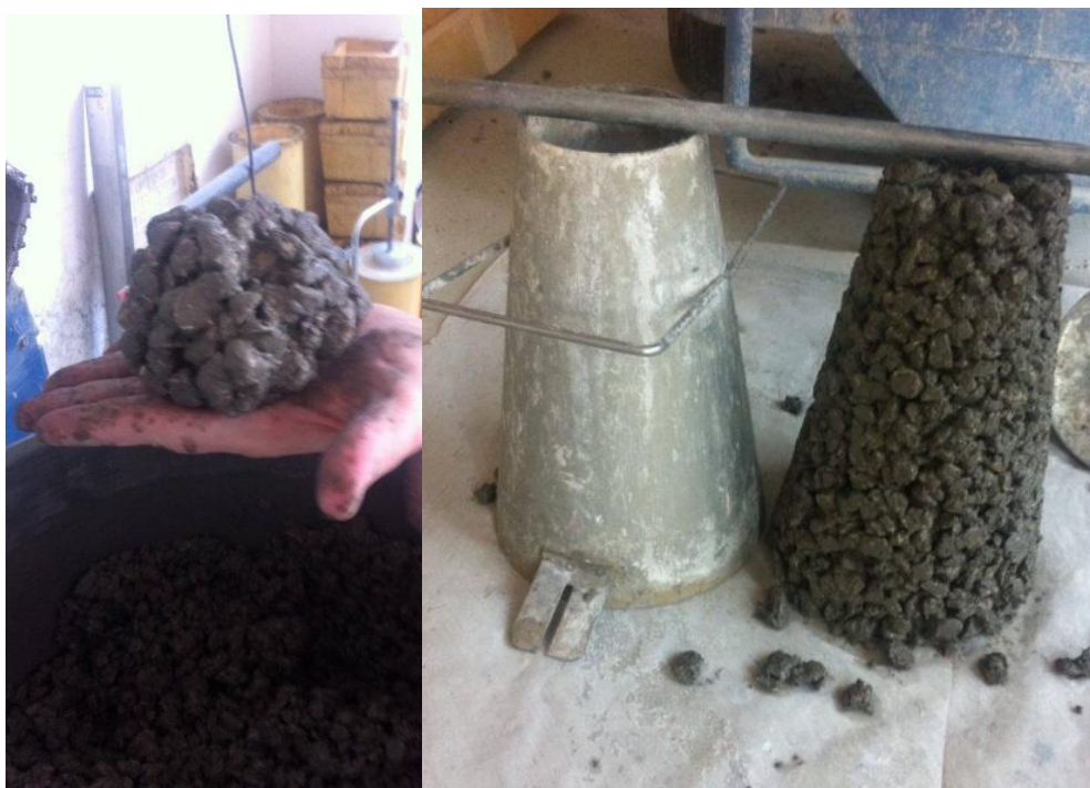
Slika 5.9 Ispitivanje konzistencije mješavine P 8 .
