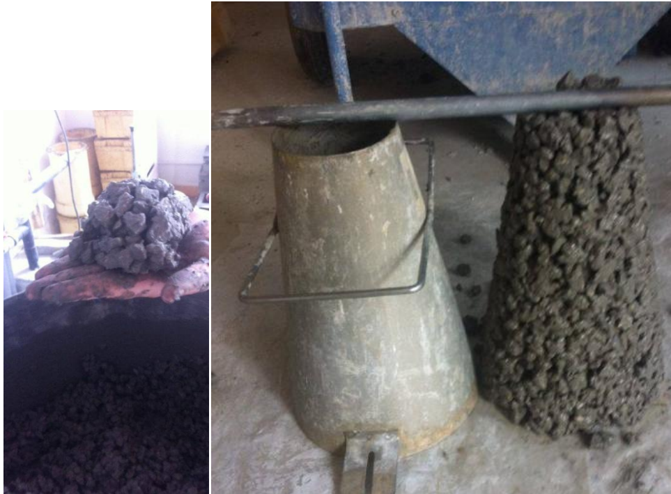
Slika 5.7 Ispitivanje konzistencije mješavine P 6
