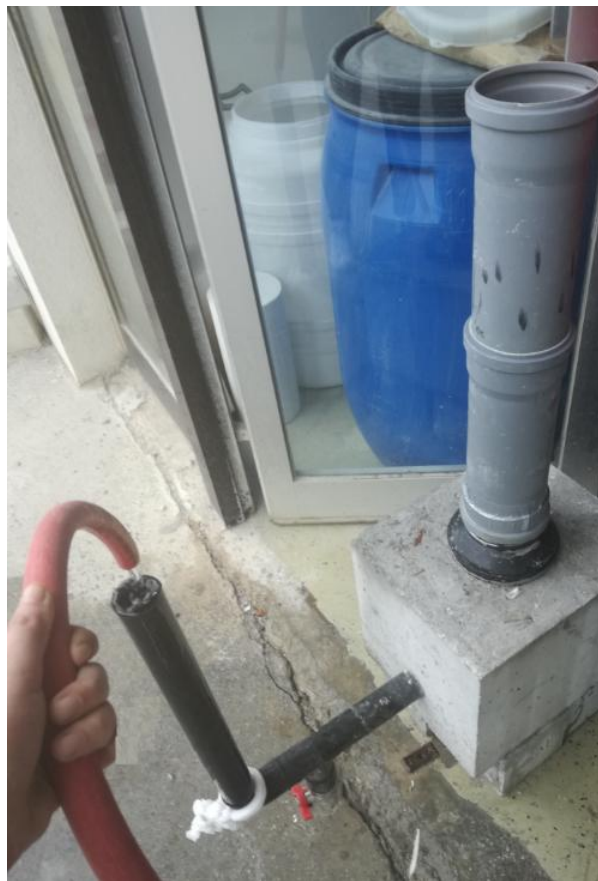
Slika 4.9 Ispitivanje propusnosti metodom padajuće razine stupca vode
