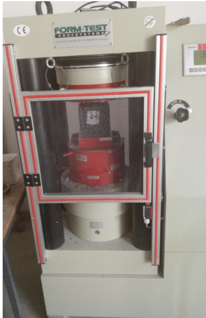
Slika 4.11 Ispitivanje tlačne čvrstoće hidrauličkom prešom
