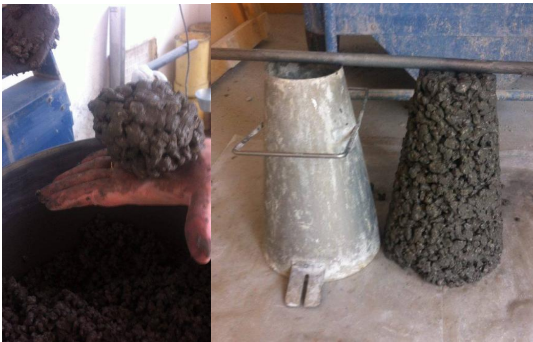
Slika 5.8 Ispitivanje konzistencije mješavine P 7 .
