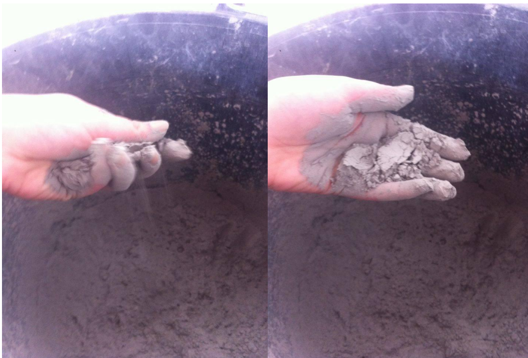
Slika 4.4 Leteći pepeo koji se koristio za izradu poroznih mješavina
