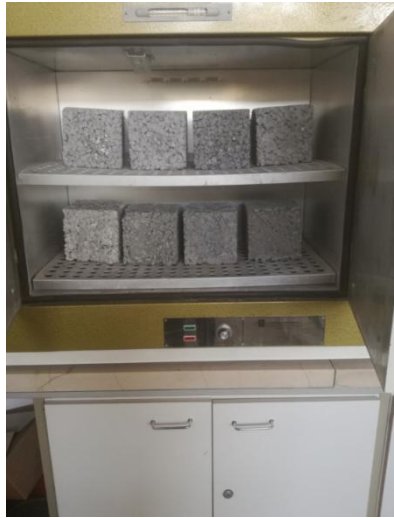
Slika 4.8 Sušenje uzoraka u pećnici
