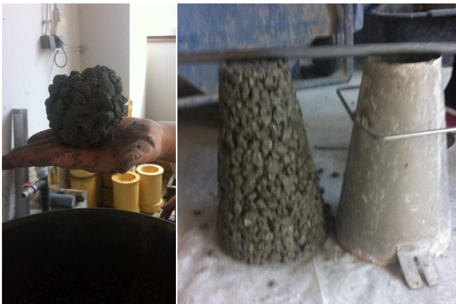
Slika 5.6 Ispitivanje konzistencije mješavine P_5 uz korekciju
