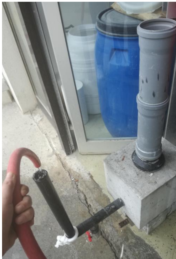
Slika 4.9 Ispitivanje propusnosti metodom padajuće razine stupca vode
