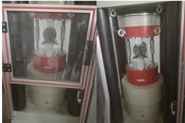
Slika 4.12 Preša za ispitivanje vlačne čvrstoće cijepanjem
