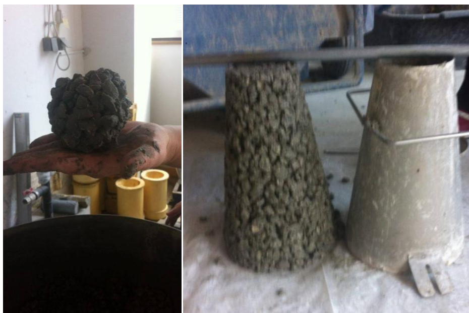
Slika 5.6 Ispitivanje konzistencije mješavine P_5 uz korekciju
