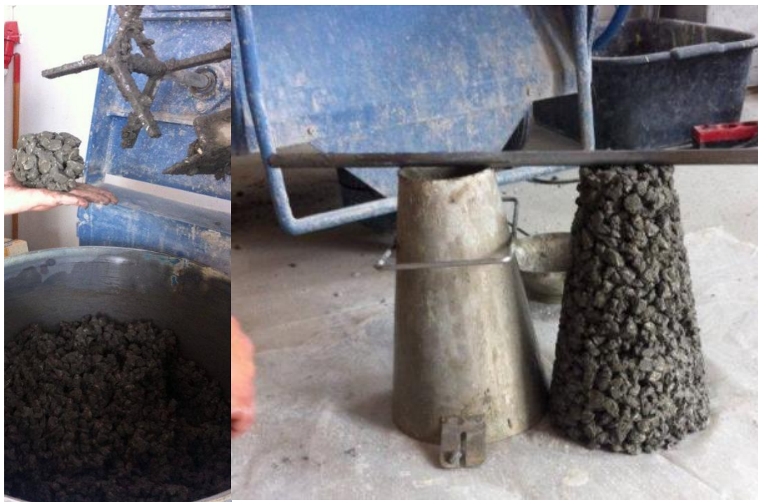
Slika 5.2 Ispitivanje konzistencije mješavine P_2 .
