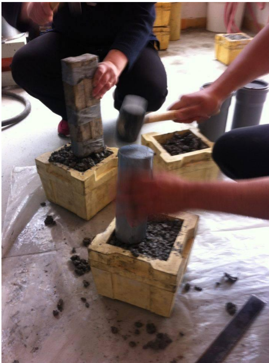
Slika 4.5 Ugradnja mješavina drvenom letvom s čekićem i betonskim valjkom
