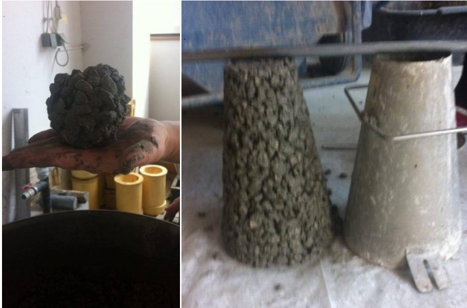
Slika 5.6 Ispitivanje konzistencije mješavine P_5 uz korekciju
