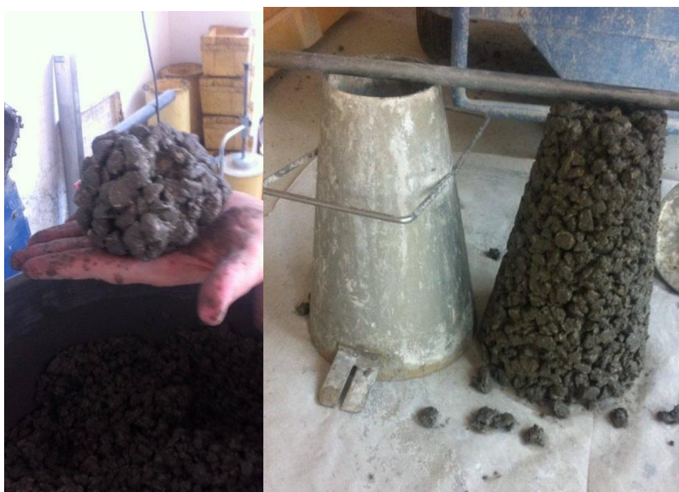
Slika 5.9 Ispitivanje konzistencije mješavine P 8 .
