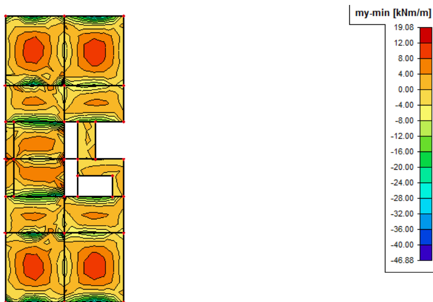
Slika 10.9 Maximalni moment savijanja m_y za kombinaciju 1,35G+1,5Q+1,5vjetar za ploče u prizemlju (poslovni prostori nad garažom)
