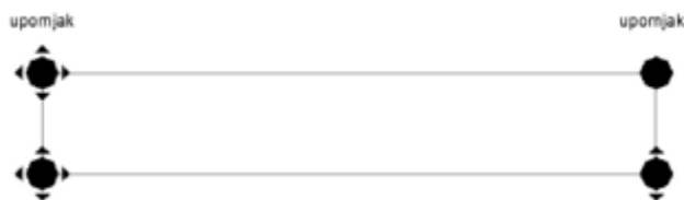
Slika 27. Ležajni sustav mosta
