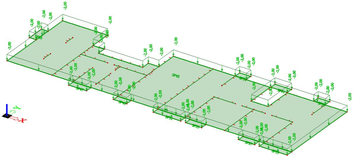
Crtež 8.2. Dodatno stalno opterećenje  $G$  [ $\text{kN/m}^2$ ]
