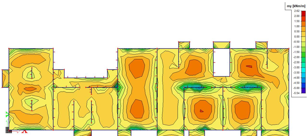
Crtež 8.11. Potrebna armatura [ $\text{cm}^2/\text{m}$ ] u Y smjeru
