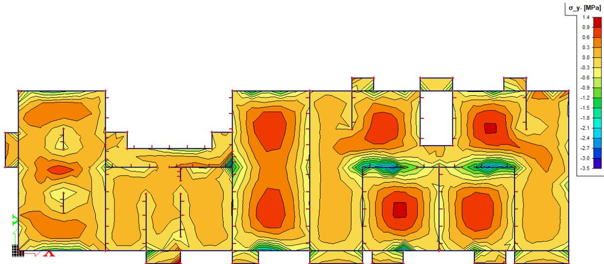
**Crtež 8.9.** Tlačna naprežanja u betonu na donjoj plohi ploče  $\sigma_{c,y,-}$  [MPa] u smjeru Y za nazovistalnu kombinaciju GSU-2:  $1,0*(G_0+G) + 0,3Q$
