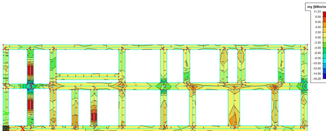
Crtež 8.40. Potrebna armatura [ $\text{cm}^2/\text{m}$ ] u Y smjeru
