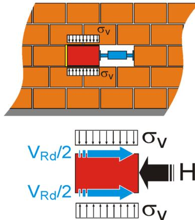
Crtež 2.5. Ispitivanje posmične čvrstoće зида – in situ
