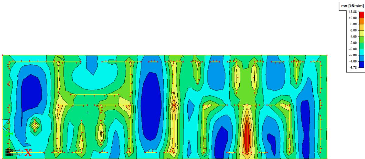
Crtež 8.46. Potrebna armatura [ $\text{cm}^2/\text{m}$ ] u X smjeru
