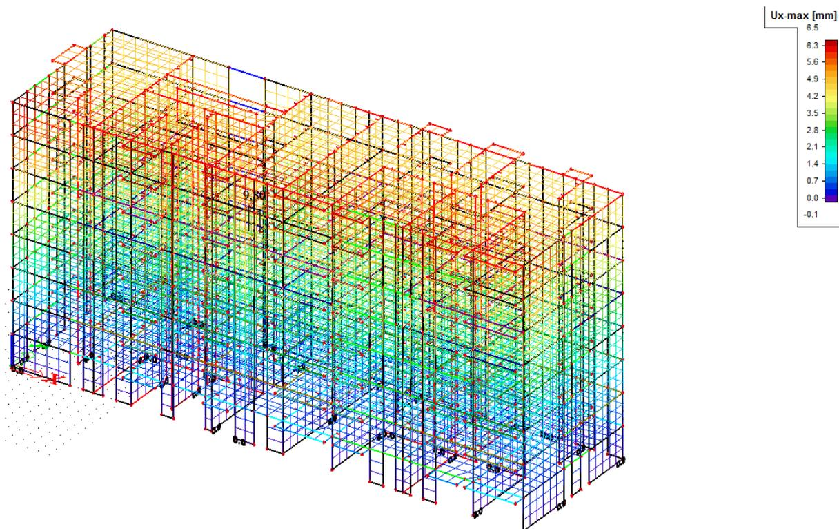
**Crtež 6.9.** Deformacija konstrukcije konstrukcije u smjeru osi  $x$
