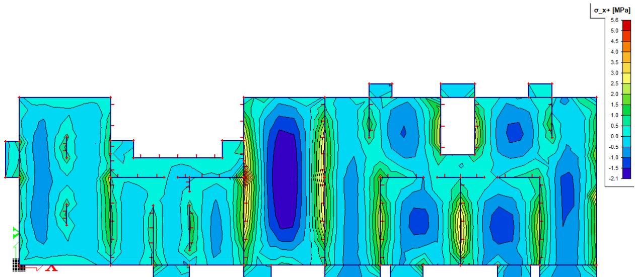
**Crtež 8.6.** Tlačna napreznja u betonu na gornjoj plohi ploče  $\sigma_{c,x,+}$  [MPa] u smjeru X za nazovistalnu kombinaciju GSU-2:  $1,0 \times (G_0 + G) + 0,3Q$
