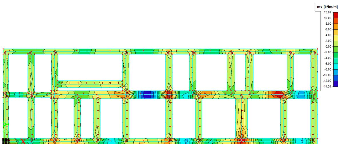
Crtež 8.39. Potrebna armatura [ $\text{cm}^2/\text{m}$ ] u X smjeru
