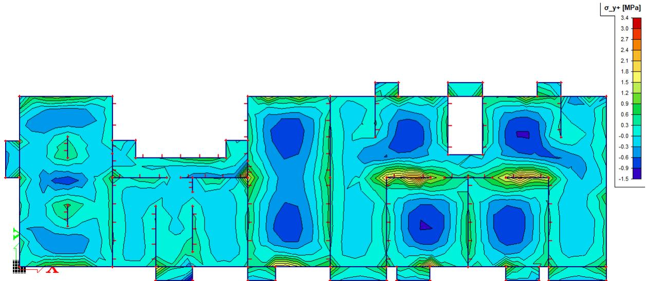
Crtež 8.7. Tlačna naprezanja u betonu na gornjoj plohi ploče  $\sigma_{c,y,+}$  [MPa] u smjeru Y za nazovistalnu kombinaciju GSU-2:  $1,0*(G_0+G) + 0,3Q$
