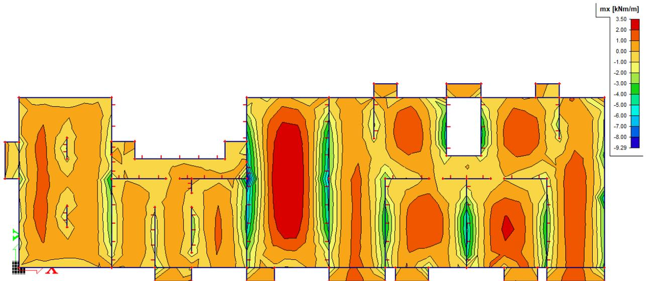
Crtež 8.10. Potrebna armatura [ $\text{cm}^2/\text{m}$ ] u X smjeru
