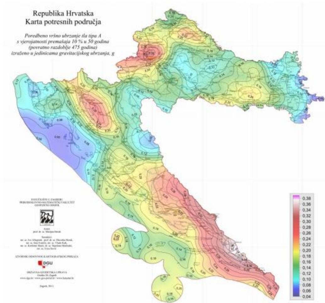
**Crtež 4.4.** Karta potresnih područja Hrvatske za poredbena vršna ubrzanja temeljnog tla  $a_{gr}$  za temeljno tlo tipa A, za poredbeno povratno razdoblje potresa  $T_{NCR} = 475$  godina
