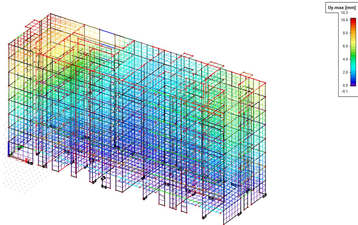
**Crtež 6.10.** Deformacija konstrukcije u smjeru osi y
