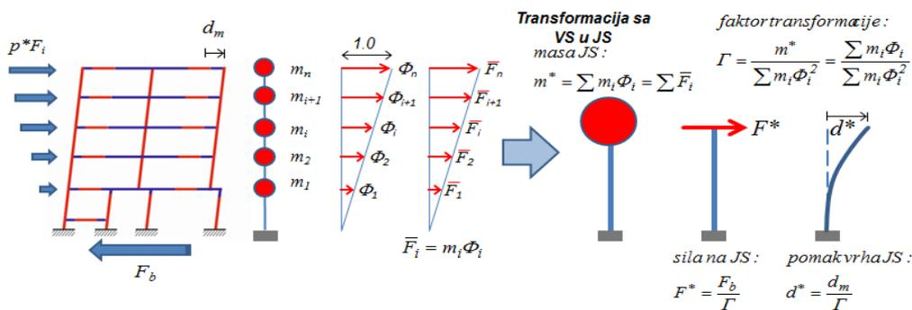
Crtež 7.7. Shematski prikaz transformacije višestupnjevnog sustava u ekvivalentni jednostupnjevni
