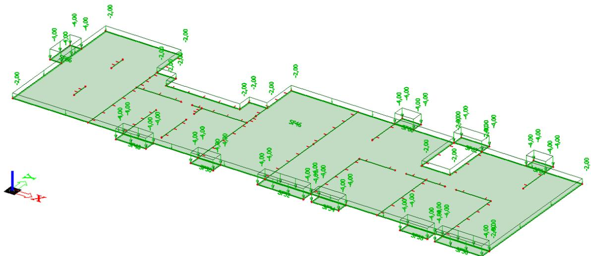
Crtež 8.3. Uporabno opterećenje  $Q$  [ $\text{kN/m}^2$ ]
