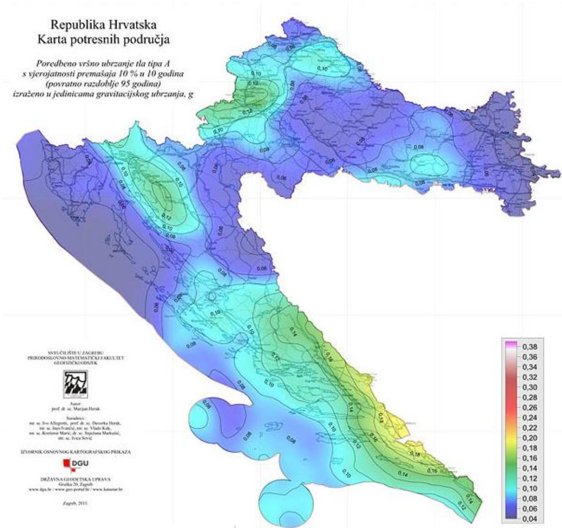
**Crtež 4.5.** Karta potresnih područja Hrvatske za poredbena vršna ubrzanja temeljnog tla  $a_{gr}$  za temeljno tlo tipa A, za poredbeno povratno razdoblje potresa  $T_{NCR} = 95$  godina
