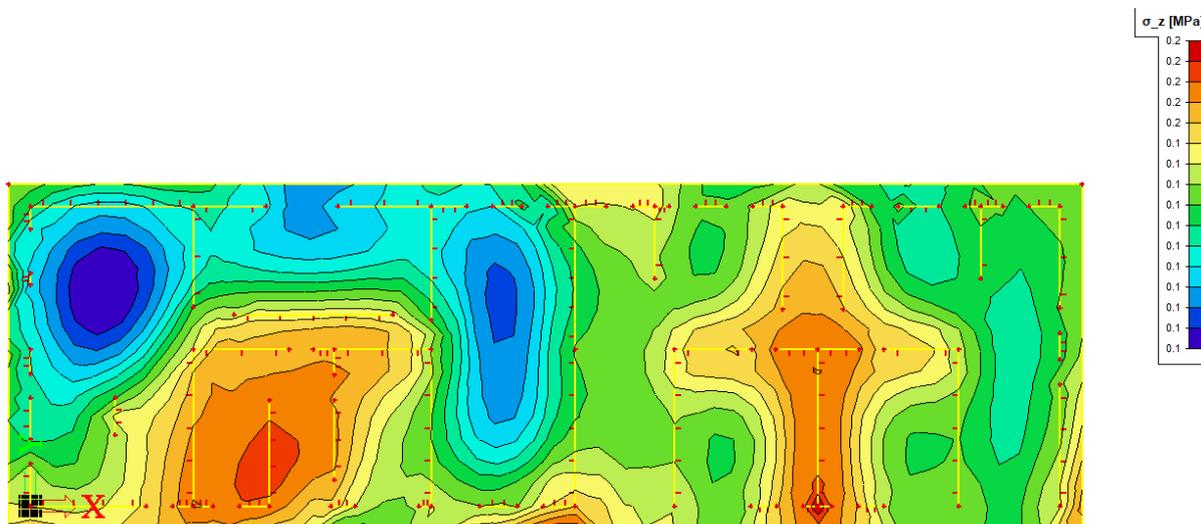
Crtež 8.42. Naprezanja [kPa] na kontaktu temeljnih stopa/tlo za kombinaciju
