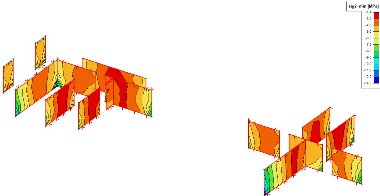
Crtež 8.24. Naprezanja u zidu  $\sigma_{c,Rd}$ , ANV 10-13
