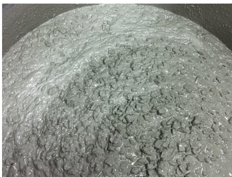
Slika 6.11.: Zgušnjavanje mješavine N1 - tiksotropija
