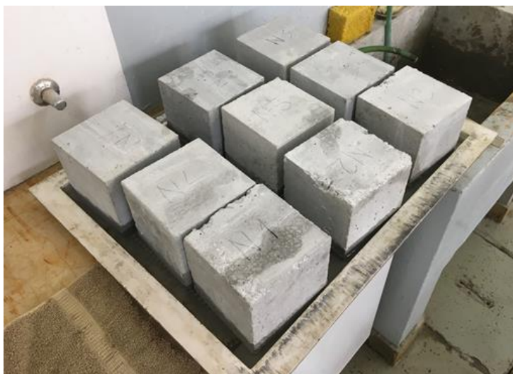
Slika 6.30.: Betonski uzorci uronjeni u vodu
