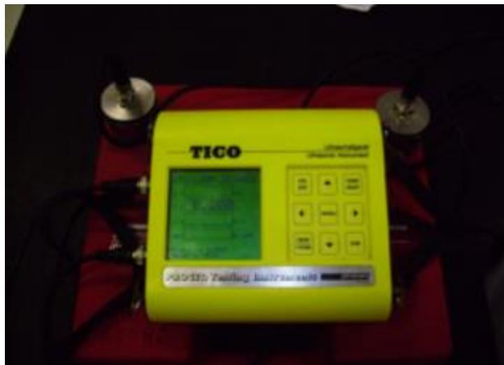
Slika 4.8.: Ultrazvučni uređaj TICO Proceq Testing Instruments [3]
