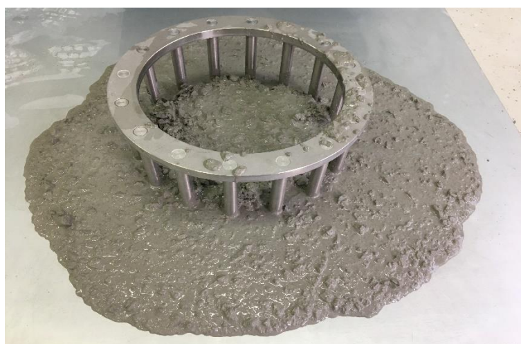
Slika 6.15.: Ispitivanje J-ringa (mješavina N8)
