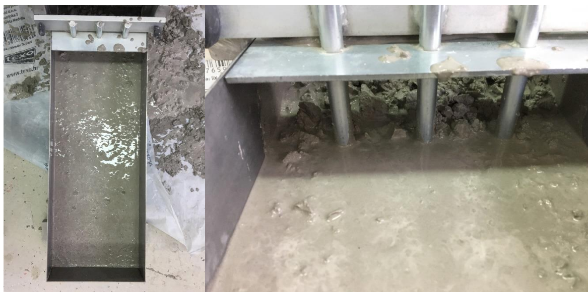
Slika 6.20.: Ispitivanje L – kutijom (mješavina N9)
