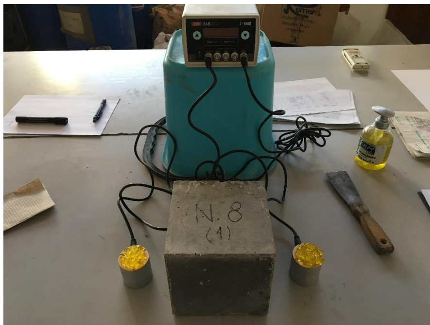
Slika 6.29.: Uređaj za ispitivanje brzine ultrazvučnih valova
