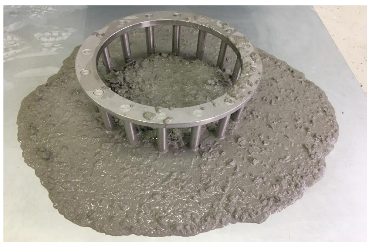
Slika 6.15.: Ispitivanje J-ringa (mješavina N8)
