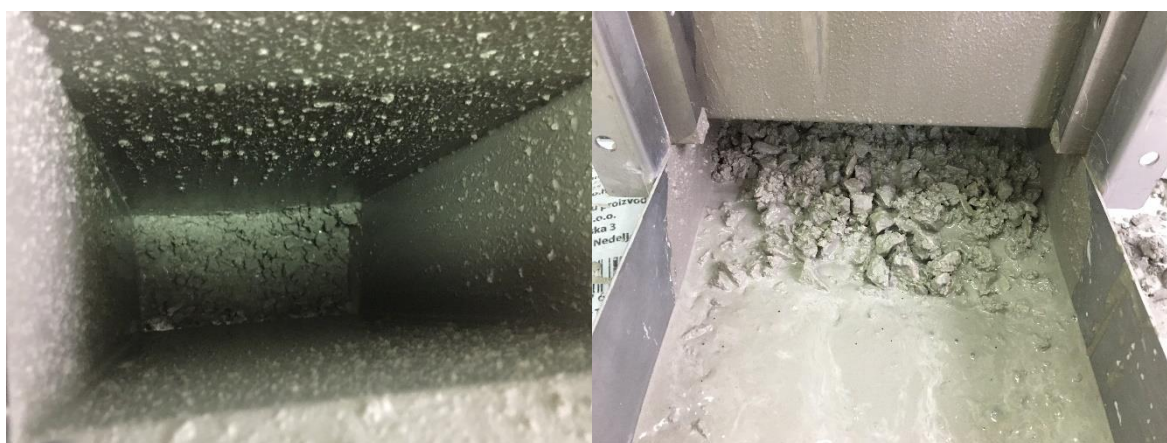
Slika 6.21.: Zadržavanje krupnog agregata na šipkama (mješavina N9)
