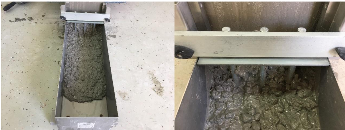
Slika 6.18.: Ispitivanje L – kutijom (mješavina N2)
