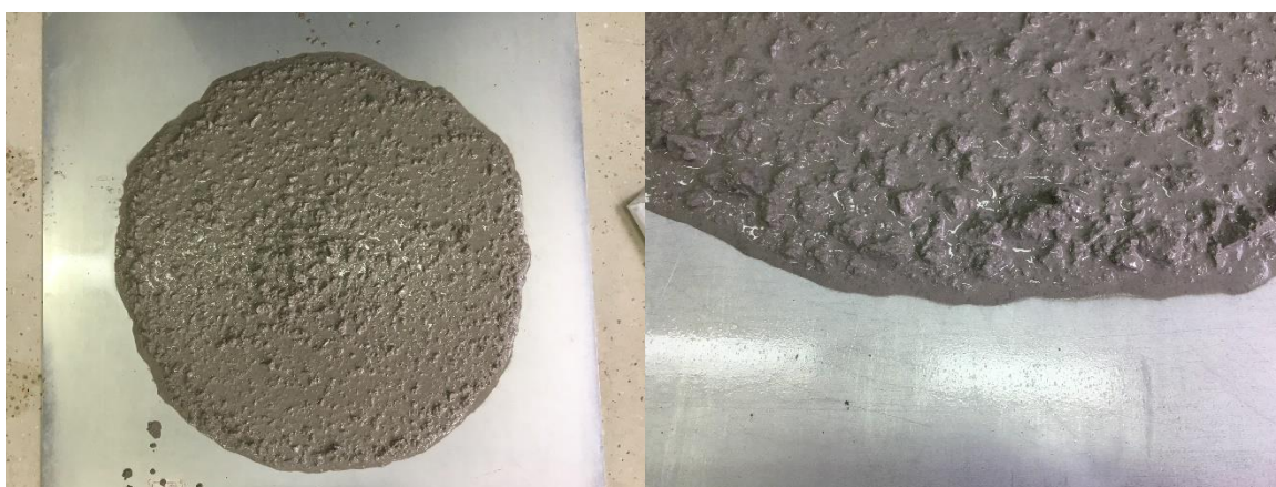
Slika 6.10.: Rasprostiranje mješavine N8 (izlučivanje vode)
