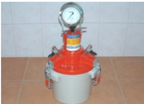
Slika 4.5.: Uređaj za ispitivanje sadržaja pora u svježem betonu [3]
