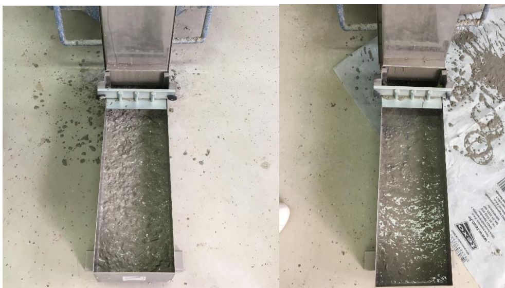
Slika 6.19.: Ispitivanje L – kutijom (mješavine N4 i N8)
