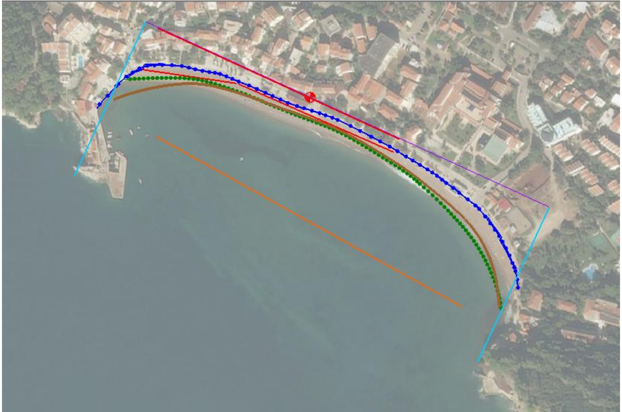
Slika 10.18 Prag širine 20 m sa gated nepropusnim rubnim uvjetima
