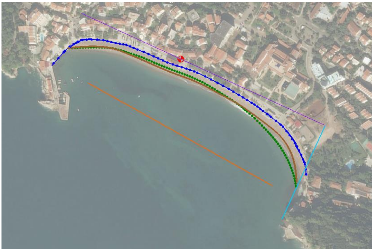
Slika 10.10 Prag širine 20 m sa skaliranim maksimalnim parametrima vala smjera S
