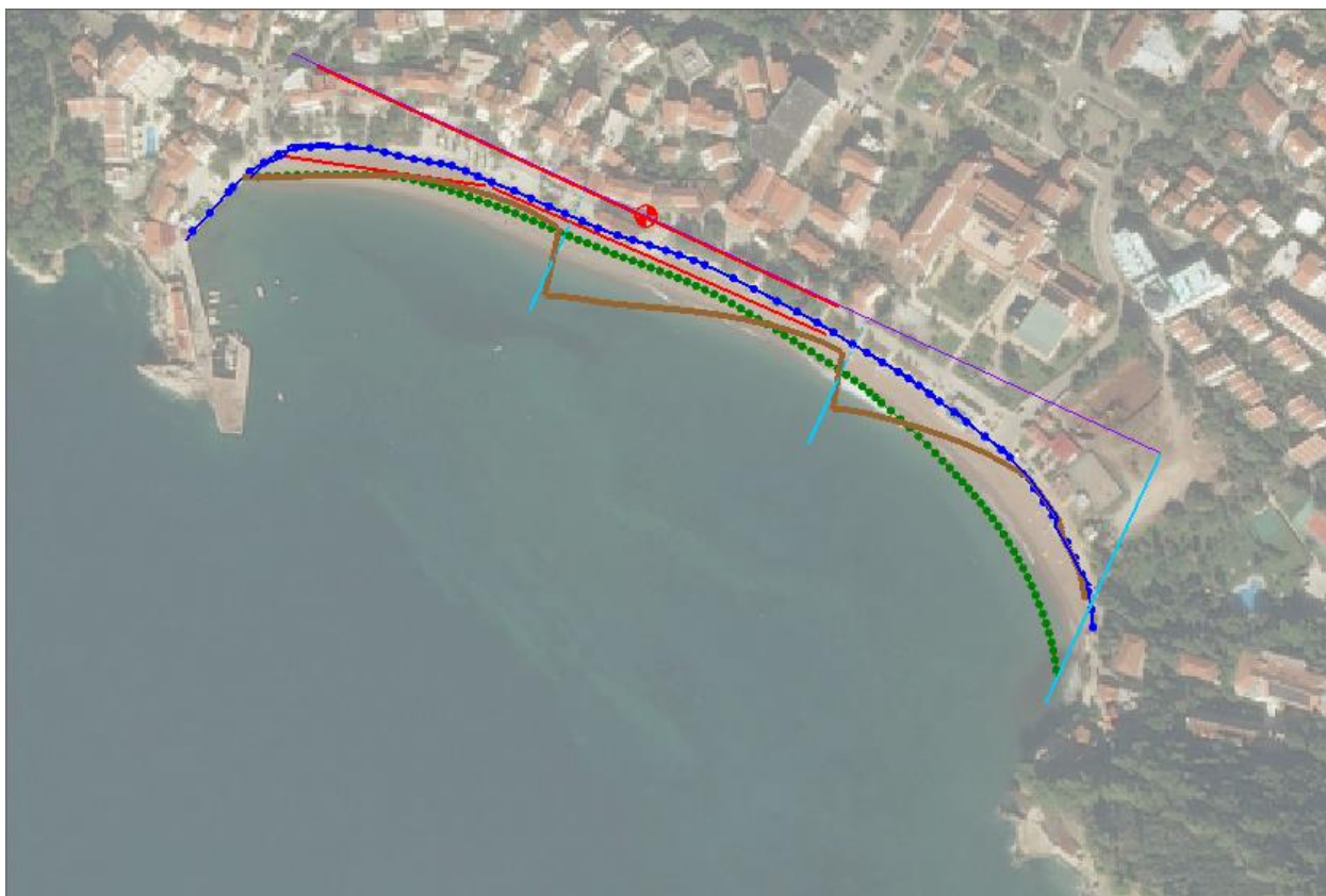
Slika 10.7 Rješenje s istočnim rubnim uvjetom - nepropusno pero 50 (m) i 2 (m) dubine
