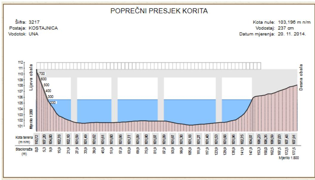
*Slika 3.11.: Poprečni presjek korita mjerne stanice Kostajnica*
