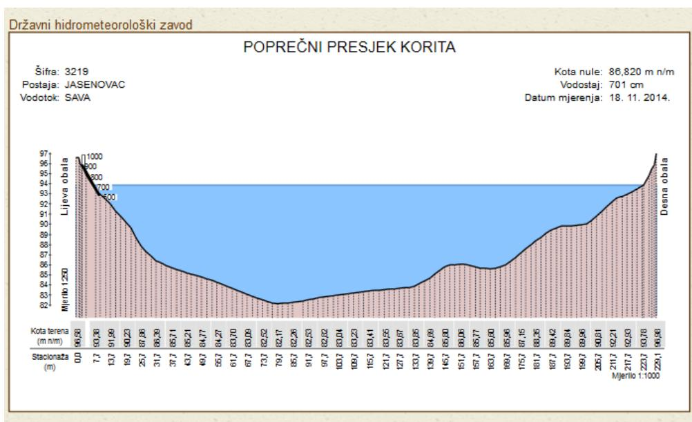
Slika 3.4.: Poprečni presjek korita mjerne stanice Jasenovac
