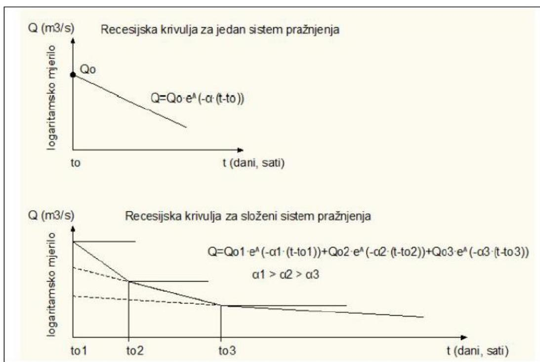
Slika 6.3.: Recesjska krivulja u polu-logaritamskom mjerilu za jednostavni i složeni sistem pražnjenja
