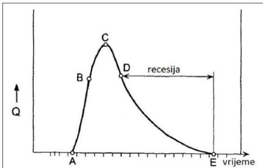
*Slika 6.1.: Osnovni dijelovi hidrograma, naglašen dio recesije*
