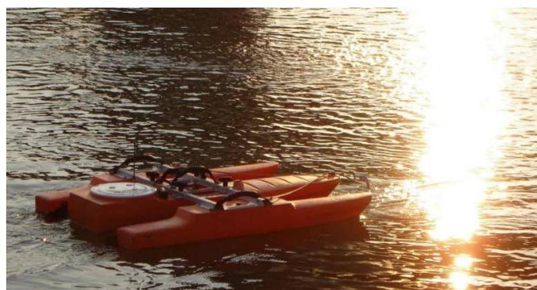
*Slika 4.3.: T-RDI akustički Doppler uređaj za mjerjenje protoka, ADCP*
