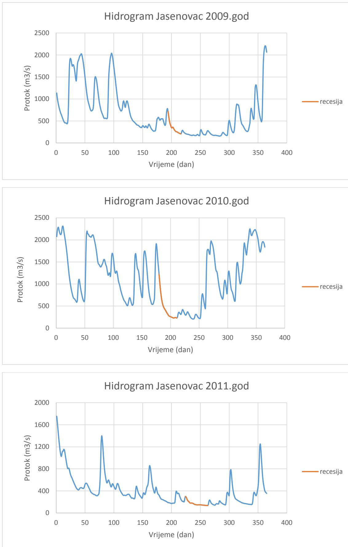
Slika 4.7.: Hidrogrami za mjernu stanicu Jasenovac za 2009. – 2011. godinu
