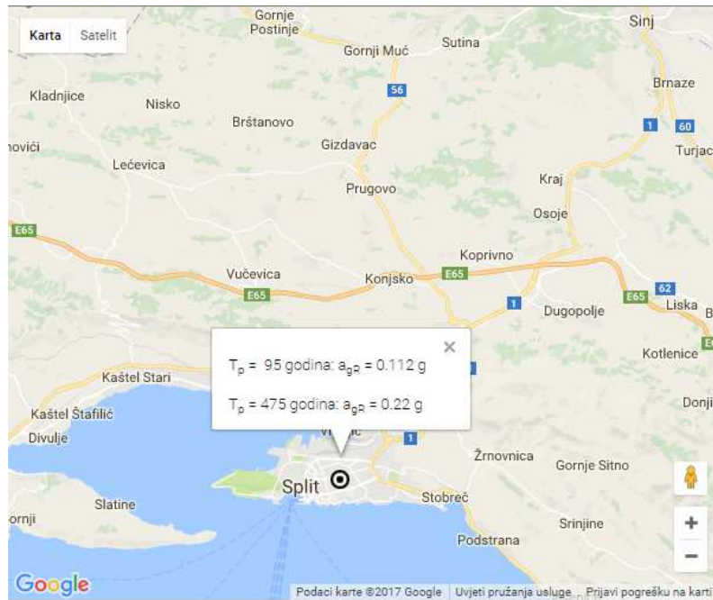
Slika 8.6 Parametar vršnog ubrzanja tla za promatranu lokaciju
