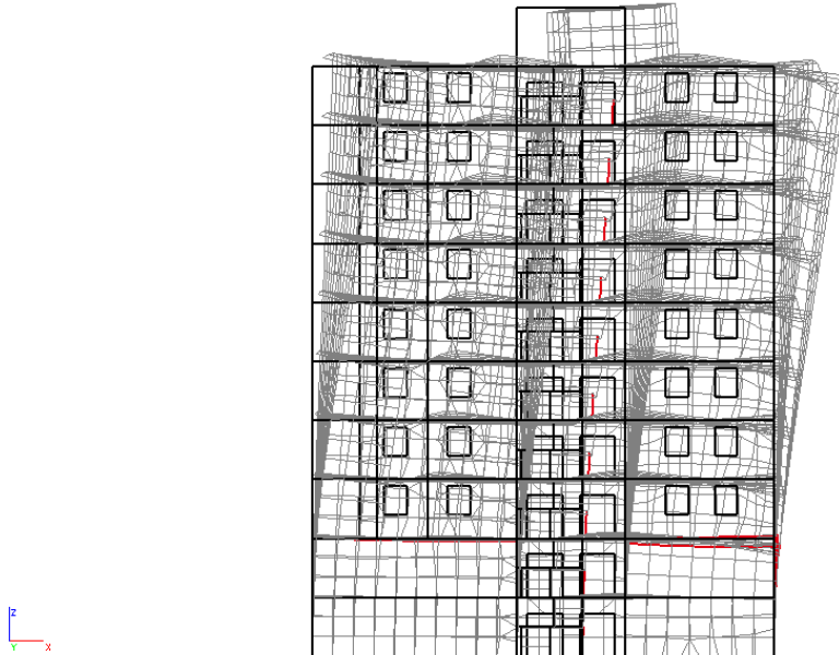
Slika 8.11. Translacija u smjeru globalne osi x - mod 1
