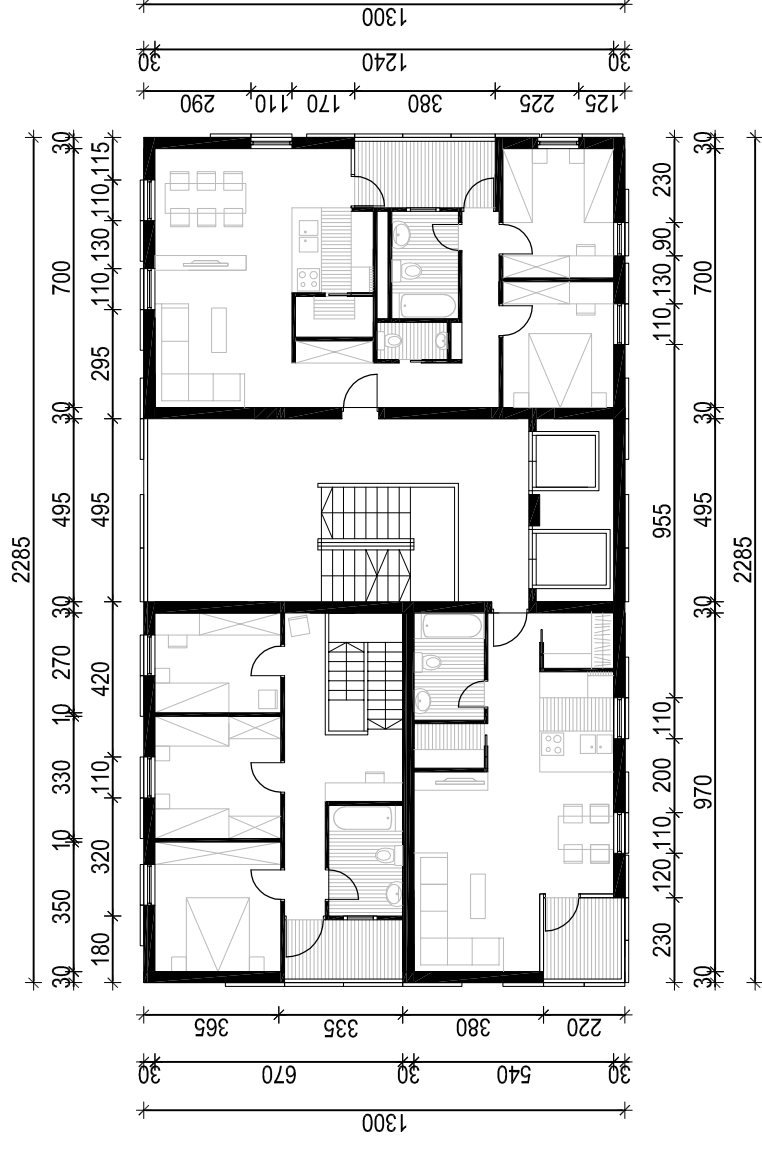
Južni toranj - parni katovi - ploča (P2)
