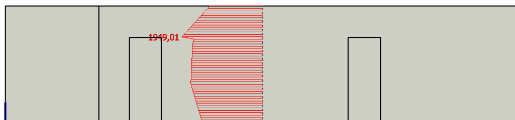
Slika 11.51. Maksimalna poprečna sila za osnovnu kombinaciju (GSN 3 - Vjetar Y)
