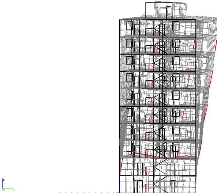
Slika 8.9. Translacija u smjeru globalne osi y - mod 1
