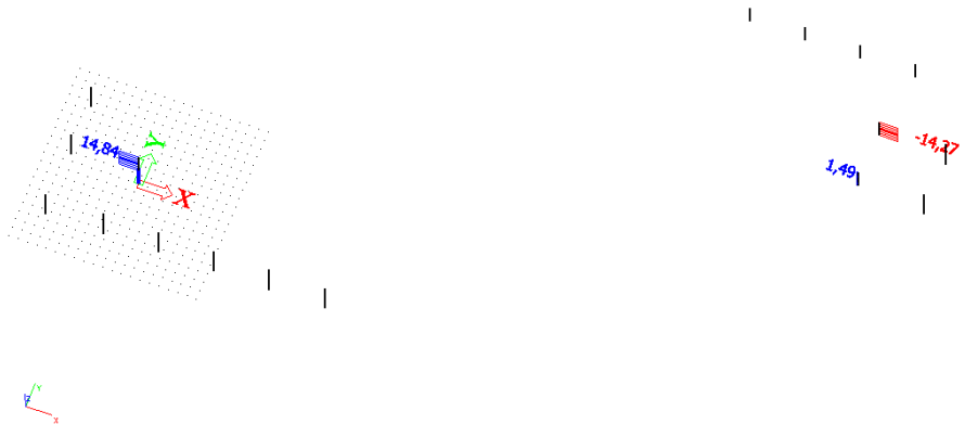
Slika 11.19. Maksimalna poprečna sila za osnovnu kombinaciju (GSN 5)
