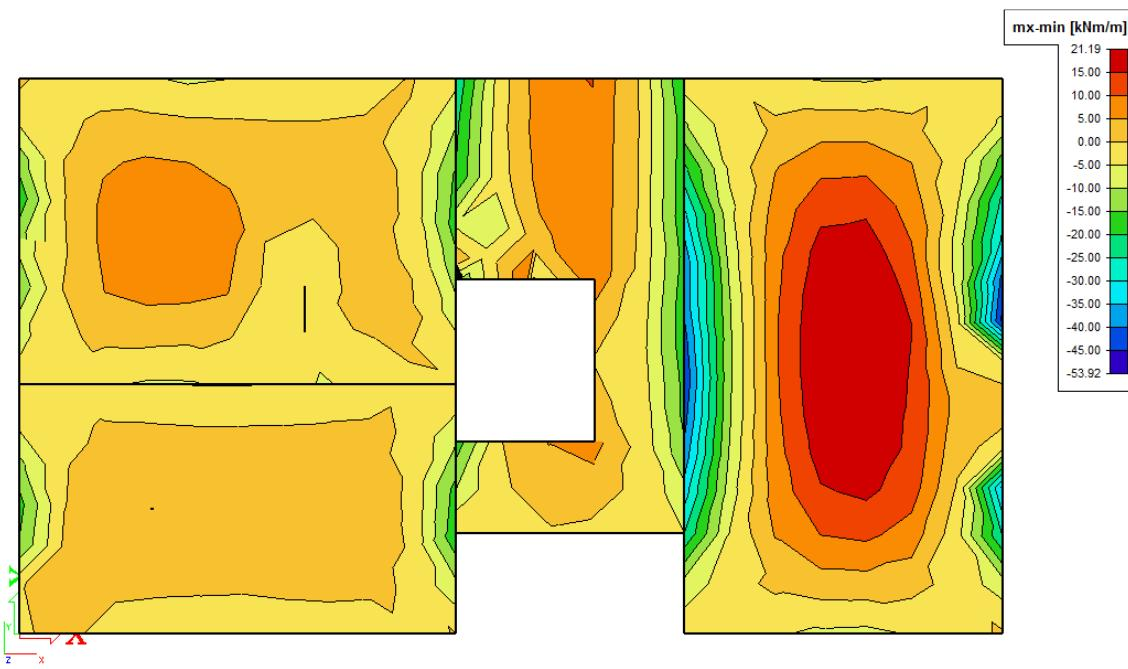
Slika 10.23. Maksimalni momenti savijanja za proračun ploče južnog tornja (neparni katovi) za kombinaciju GSU - 1
