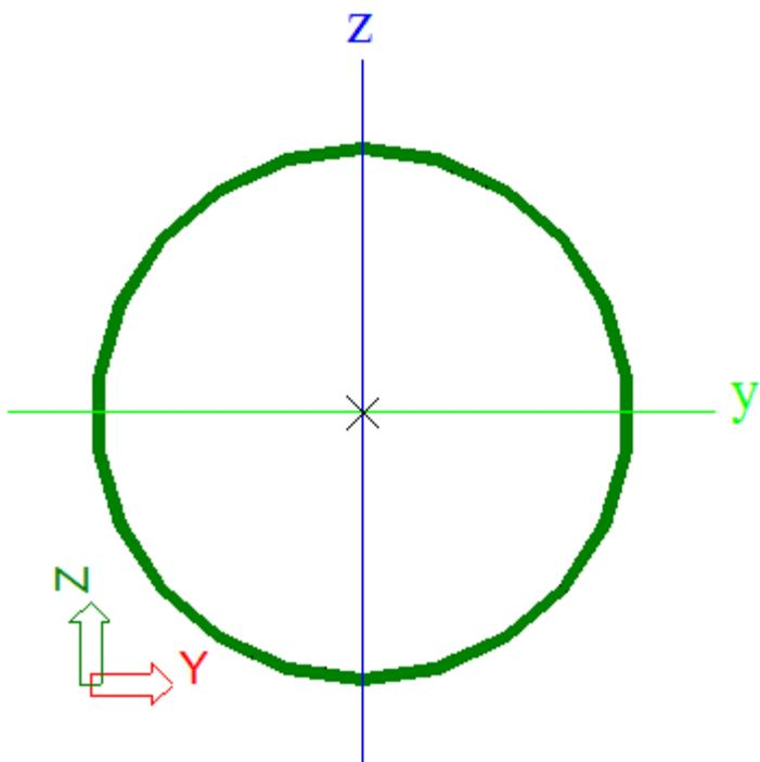
Slika 11.41. Poprečni presjek stupa S4 (CFCHS 168,3x3,2)
