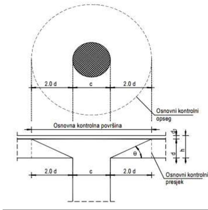
Slika 11.14. Proboj ploče
