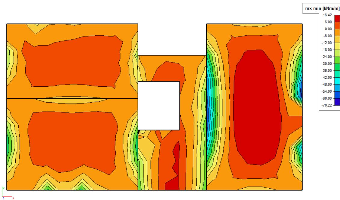
Slika 10.38. Prikaz momenata savijanja na ležajevima –  $mx$
