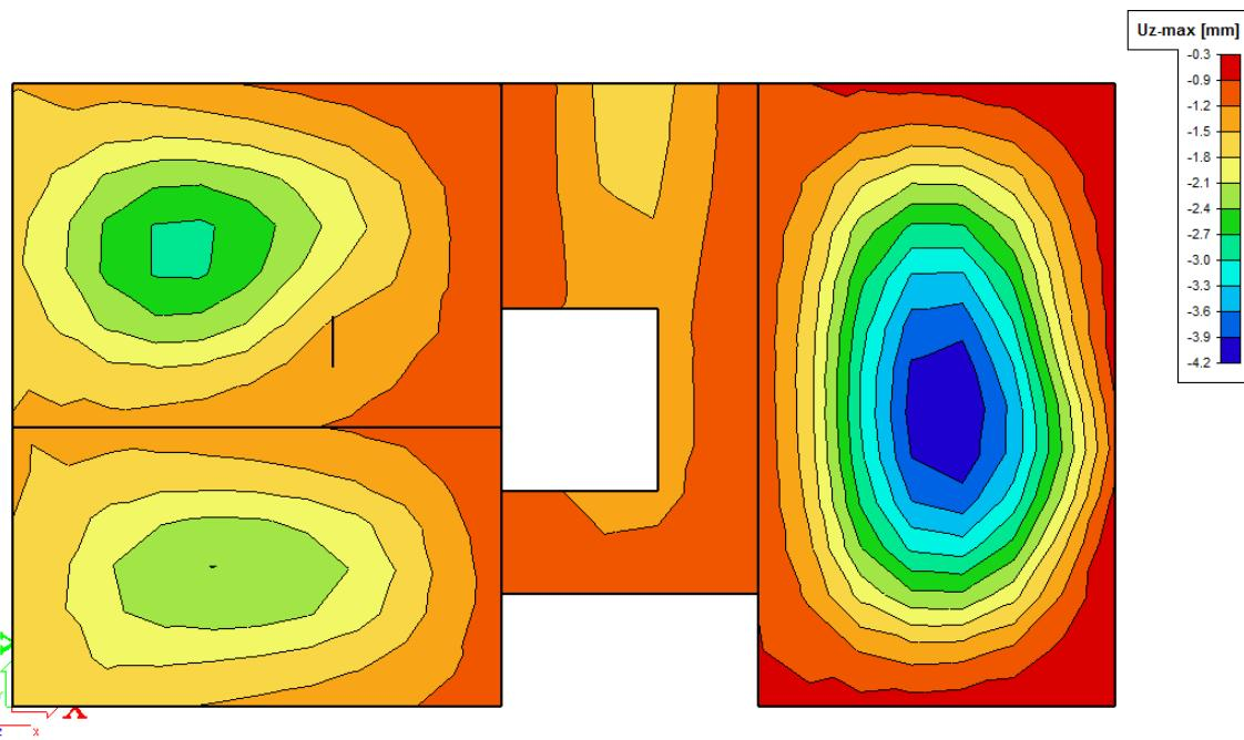
Slika 10.26. Maximalni progib za ploču južnog tornja (neparni katovi) za kombinaciju GSU - 1
