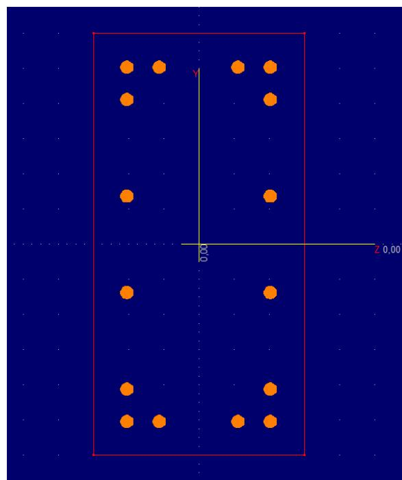
Slika 11.25. Poprečni presjek stupa S2 s armaturom (Aspalathos Section Design)
