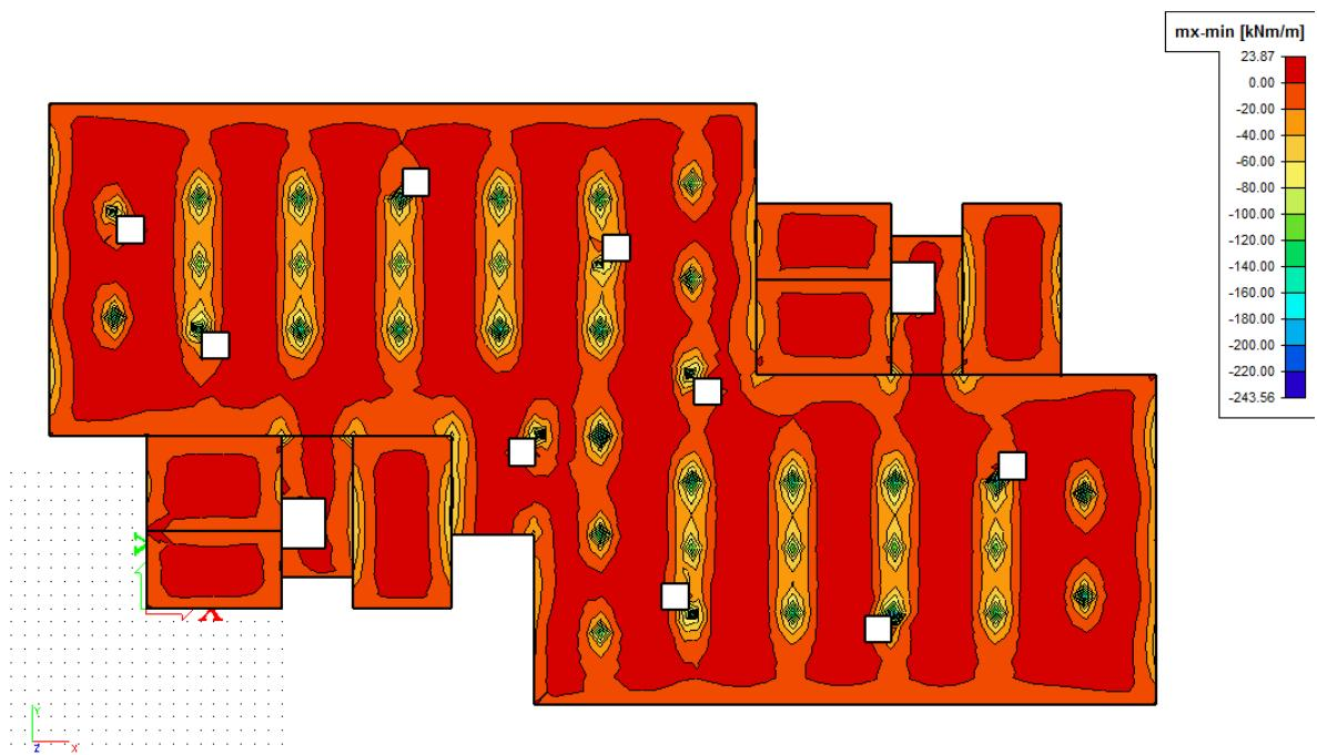
Slika 10.3. Prikaz momenata savijanja na ležajevima -  $mx$
