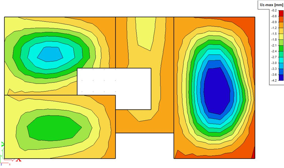
Slika 10.35. Maximalni progib za ploču južnog tornja (parni katovi) za kombinaciju GSU - 1
