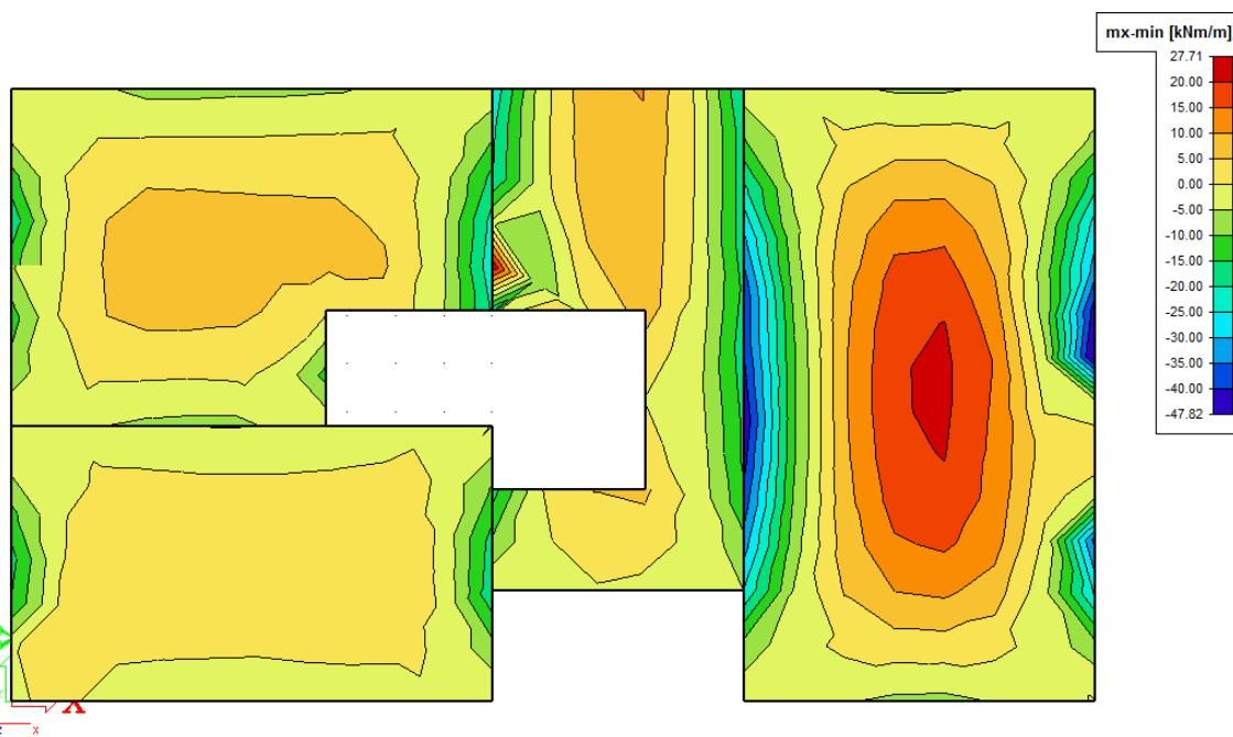
Slika 10.32. Maksimalni momenti savijanja za proračun ploče južnog tornja (parni katovi) za kombinaciju GSU1
