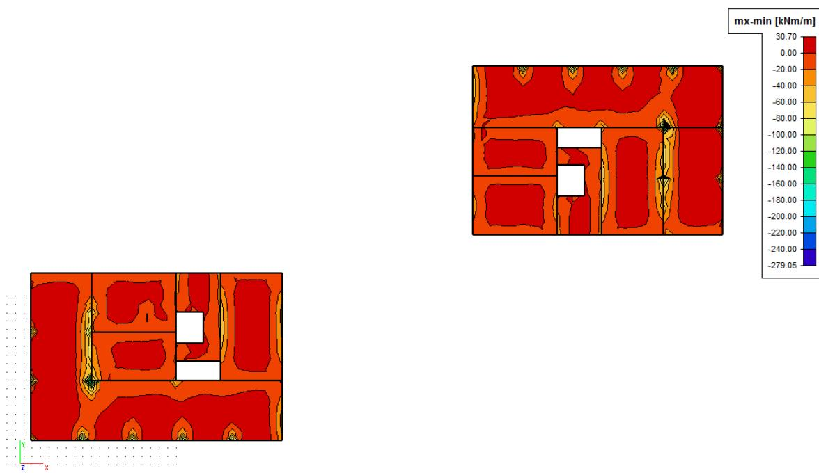
Slika 10.12. Prikaz momenata savijanja na ležajevima –  $mx$
