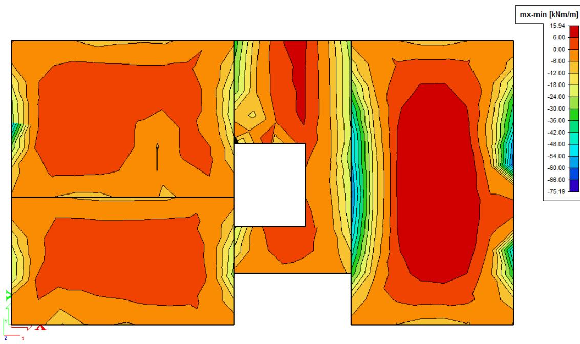
Slika 10.20. Prikaz momenata savijanja na ležajevima –  $mx$
