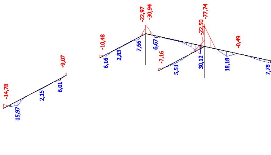
Slika 10.60. Maksimalni momenti savijanja za proračun greda sjevernog tornja za kombinaciju GSU - 1
