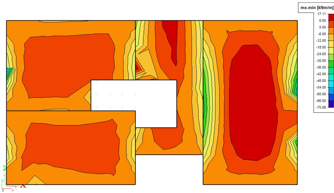
Slika 10.29. Prikaz momenata savijanja na ležajevima –  $mx$
