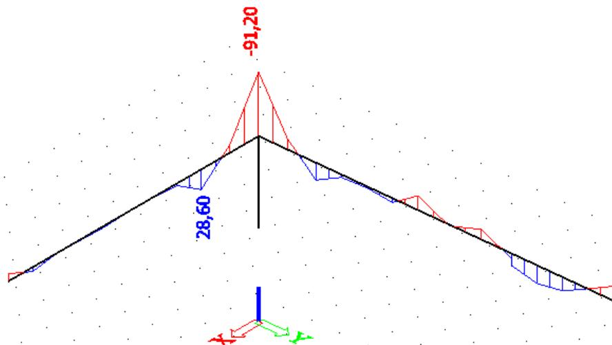
Slika 10.47. Maksimalni momenti savijanja za proračun greda južnog tornja za kombinaciju GSU - 1
