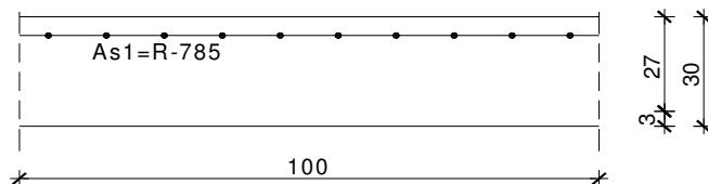
Slika 10.16. Skica armature ploče na ležaju
