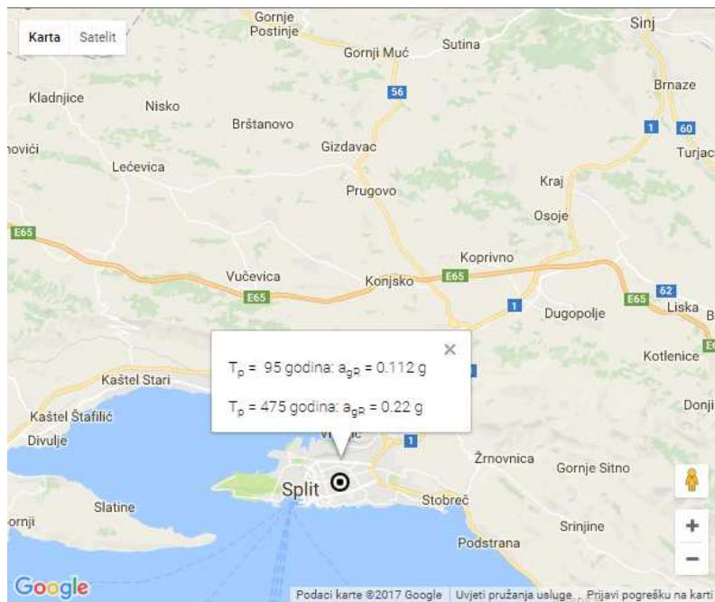
Slika 8.6 Parametar vršnog ubrzanja tla za promatranoj lokaciju
