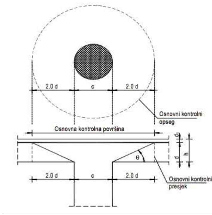
Slika 11.40. Proboj ploče
