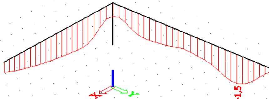
Slika 10.48. Maximalni progib za grede južnog tornja za kombinaciju GSU - 1
