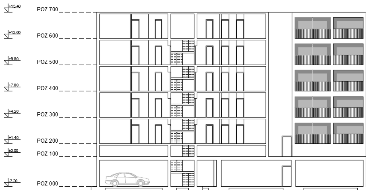
Slika 3. Presjek B-B kompleksa stambenih zgrada
