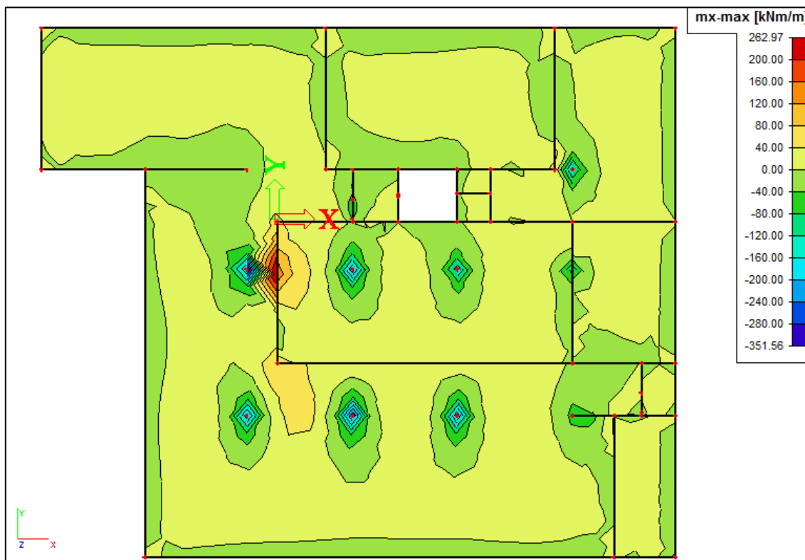
Slika 140. Dijagram momenta savijanja M_x ( \text{kNm/m} )
