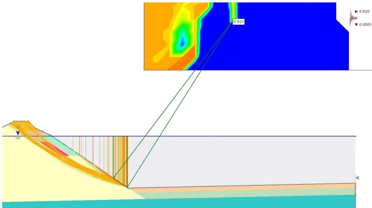
Slika 3.18. Klizne plohe minimalnog faktora sigurnosti desnog pokosa lukobrana na presjeku R.11 za PS2 ( $T_p=475g - F_v \downarrow$ )
