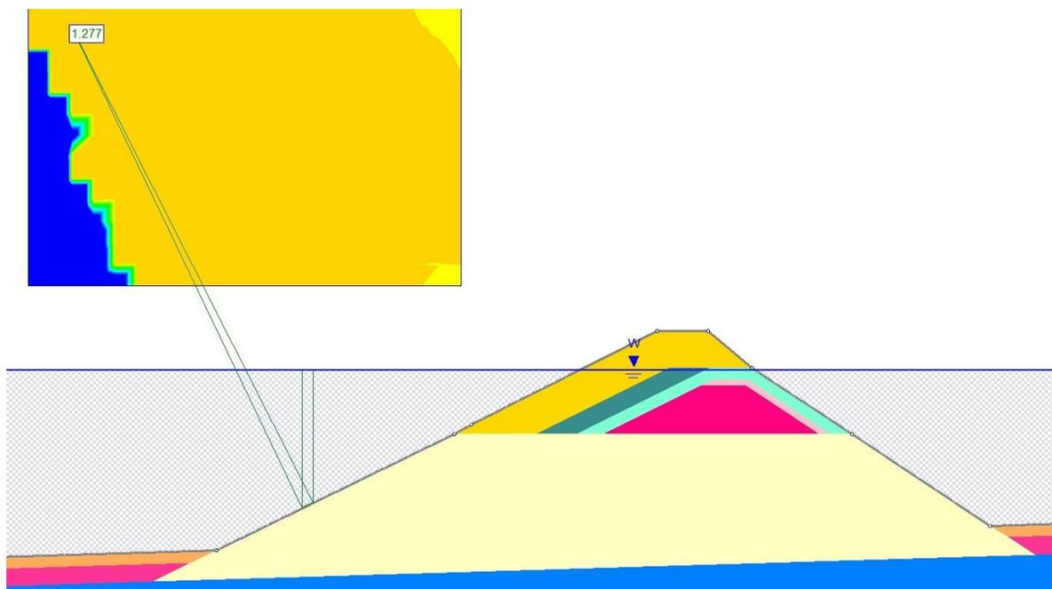
Slika 3.19. Klizna ploha minimalnog faktora sigurnosti lijevog pokosa lukobrana na presjeku R.3 prema PP3 za PSI
