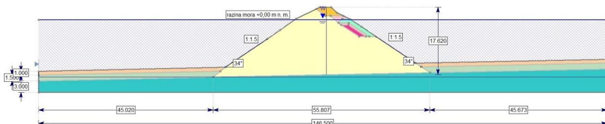
Slika 3.2. Računski model tla za presjek R.11
