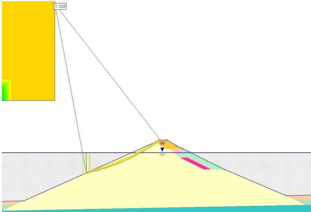
Slika 3.25. Klizne plohe minimalnog faktora sigurnosti lijevog pokosa lukobrana na novom presjeku R.11 prema PP3
