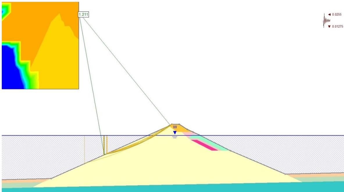
Slika 3.28. Klizne plohe minimalnog faktora sigurnosti lijevog pokosa lukobrana na novom presjeku R.11 prema PP3 za PS2 ( $T_p=95$ god -  $F_v \downarrow$ )
