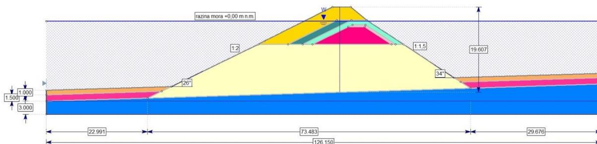
Slika 3.4. Računski model tla za presjek R.3
