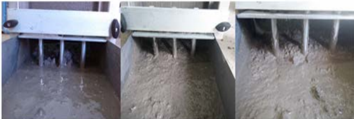
Slika 3.7. Stopa blokiranja kod SCC1, SCC2 i SCC3.
