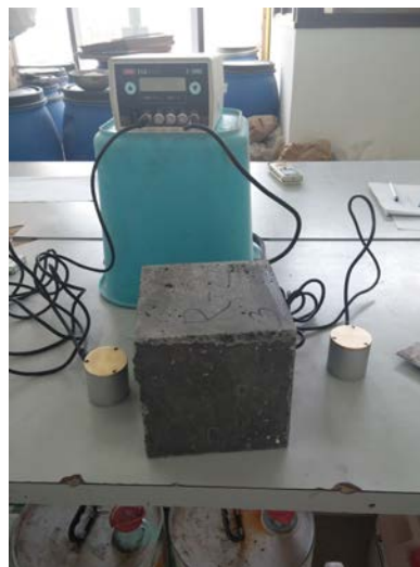
Slika 3.12. Ispitivanje ultrazvukom [slika zabilježena tijekom ispitivanja].
