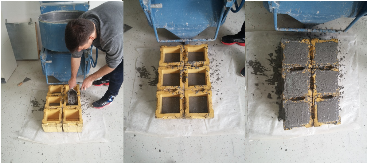
Slika 3.10. Uzorci svježeg betona [slika zabilježena tijekom ispitivanja].
