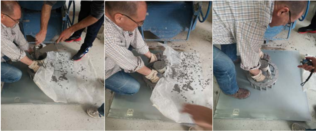
Slika 3.8. Postupak ispitivanja J-prstenom [slika zabilježena tijekom ispitivanja].
