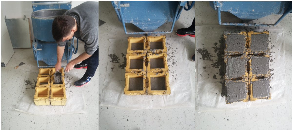
Slika 3.10. Uzorci svježeg betona [slika zabilježena tijekom ispitivanja].
