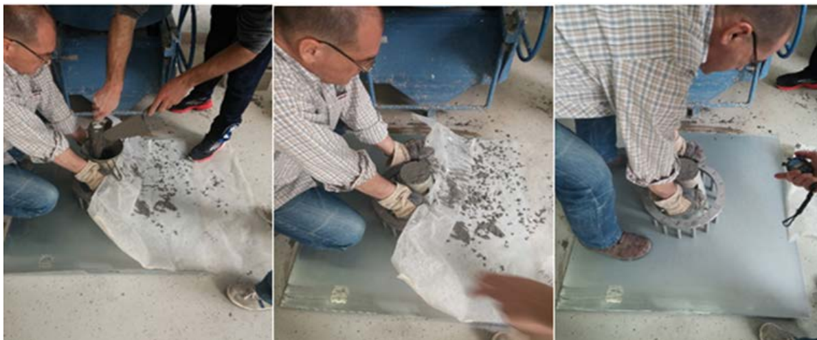
Slika 3.8. Postupak ispitivanja J-prstenom [slika zabilježena tijekom ispitivanja].
