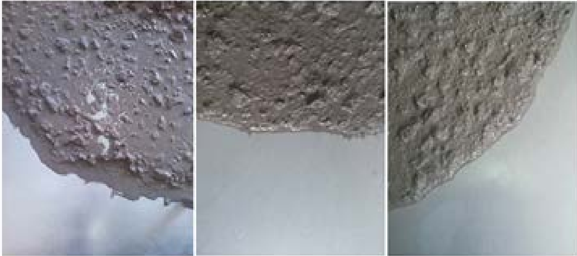
Slika 3.5. Promatranje segregacija kod mješavina SCC1, SCC2, SCC3 [slika zabilježena tijekom ispitivanja].
