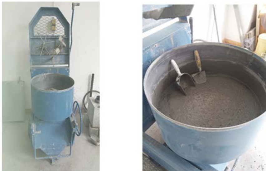
Slika 3.1. Mješalica betona i mješavina [slika zabilježena tijekom ispitivanja].
