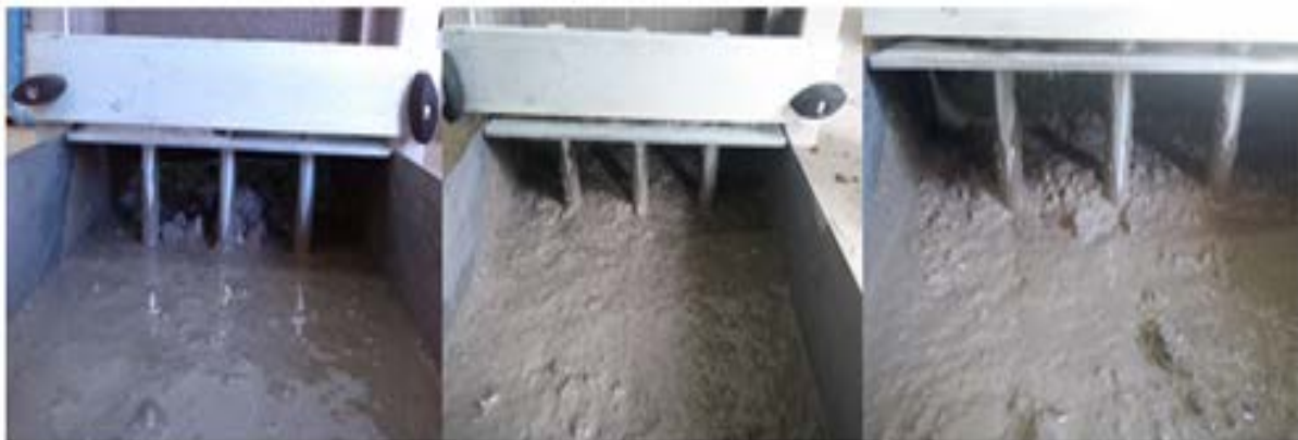
Slika 3.7. Stopa blokiranja kod SCC1, SCC2 i SCC3.
