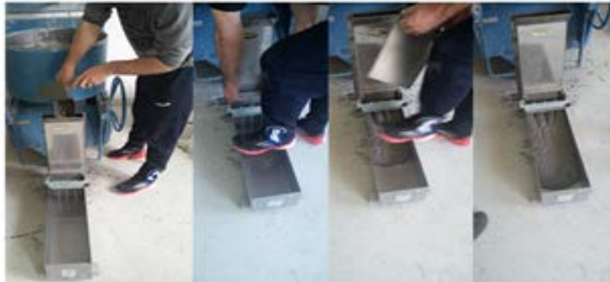
Slika 3.6. L- box uređaj [slika zabilježena tijekom ispitivanja].
