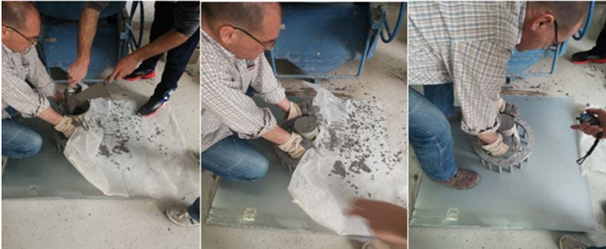
Slika 3.8. Postupak ispitivanja J-prstenom [slika zabilježena tijekom ispitivanja].
