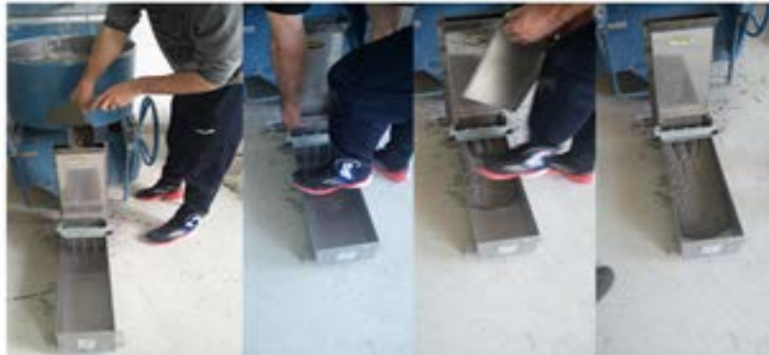
Slika 3.6. L- box uređaj [slika zabilježena tijekom ispitivanja].
