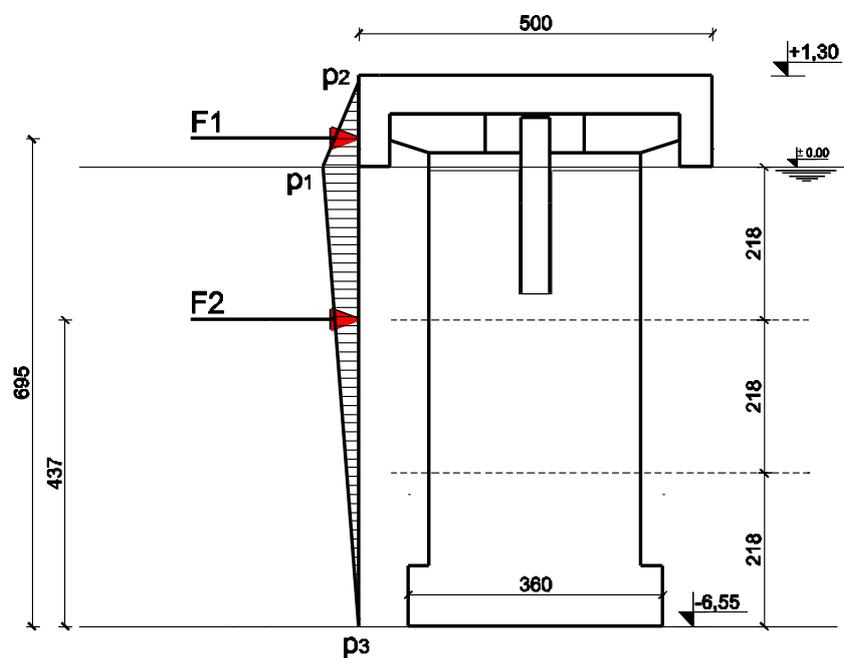
Rezultat proračuna:  $p_1 = 4,9 \text{ kN/m}^2$  ;  $p_2 = 0,0 \text{ kN/m}^2$  ;  $p_3 = 0,0 \text{ kN/m}^2$  ;  $p_u = 0,0 \text{ kN/m}^2$
