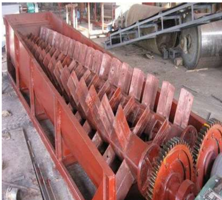
Slika 21. Stroj za pranje s noževima [21]
