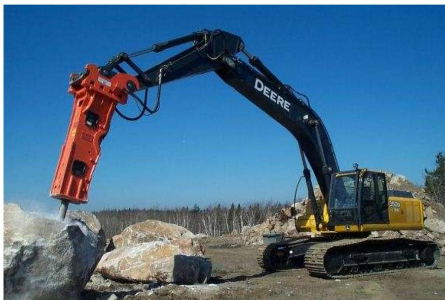
Slika 5. Hidraulični čekić montiran na ruku jaružala [6]
