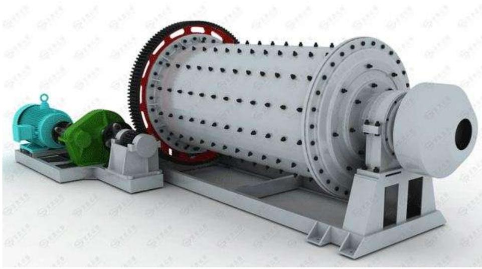
Slika 11. Mlin s kuglama [13]
