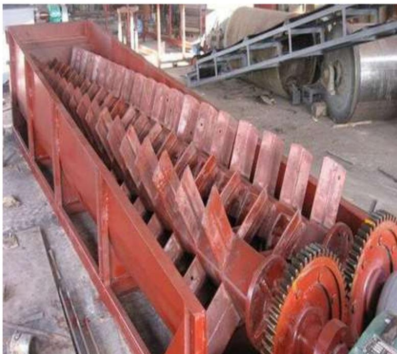
Slika 21. Stroj za pranje s noževima [21]
