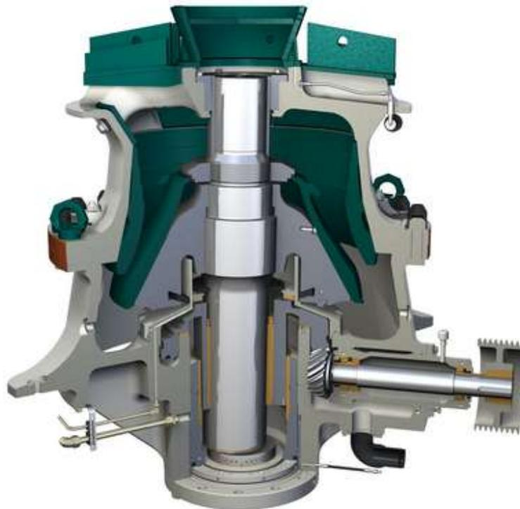
Slika 10. Shematski prikaz kružne drobilice [12]
