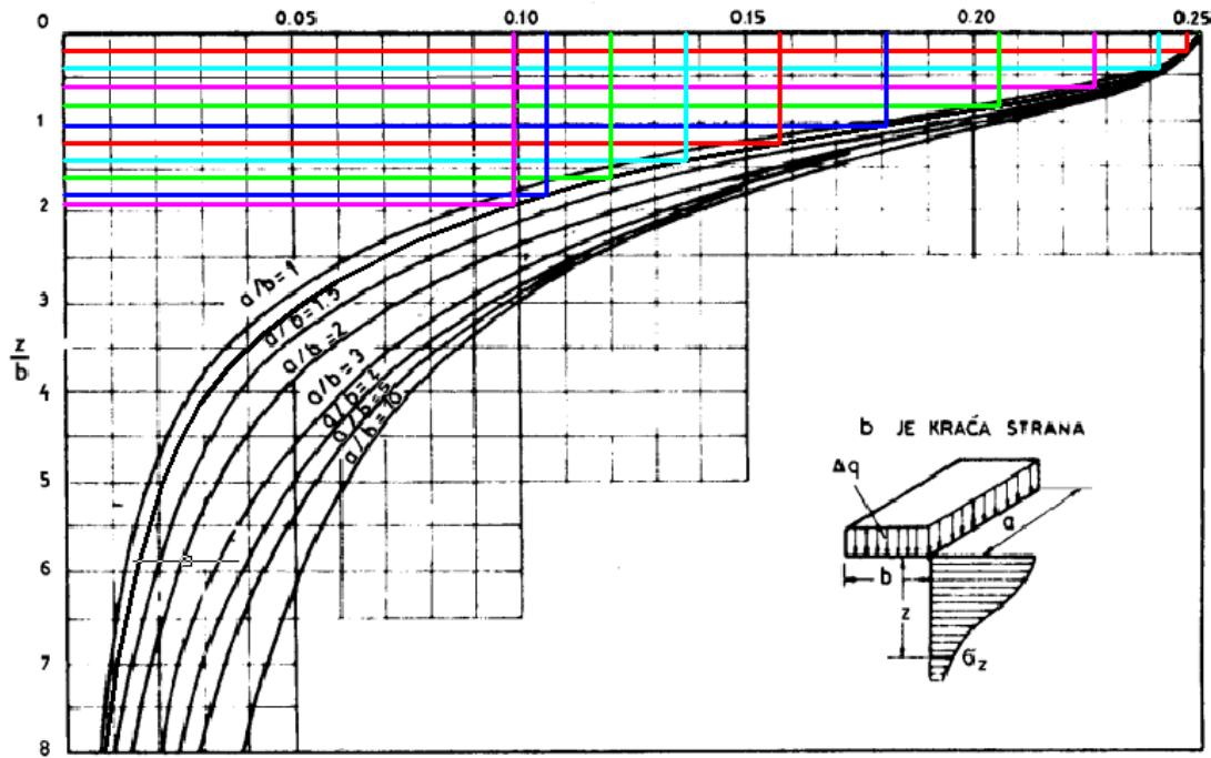
Slika 4. Steinbrenner-ov dijagram za proračun uspravnih dodatnih naprezanja
