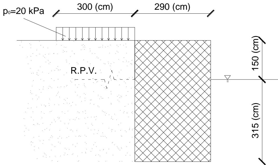
Slika 1. Karakteristični poprečni presjek obalnog zida
