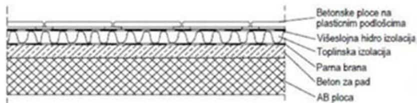
Slika 3.1. Presjek ploče poz. 100
