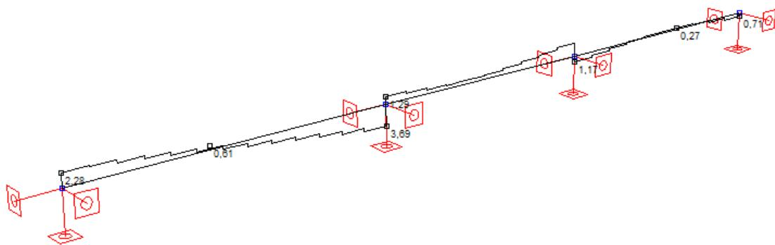
Slika 6.6. Poprečne sile  $T_y$  (kN)
