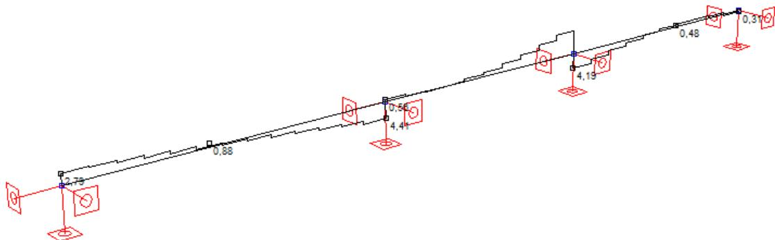
Slika 6.8. Poprečne sile  $T_y$  (kN)
