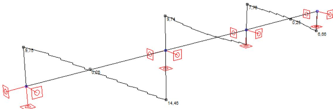
Slika 6.2. Poprečne sile Ty (kN)
