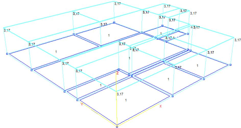
Slika 3.5 Prikaz dodatnog stalnog opterećenja  $\Delta g_{200}$
