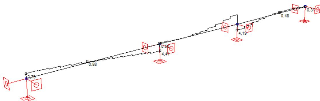
Slika 6.4. Poprečne sile  $T_y$  (kN)
