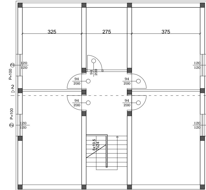
$$\begin{aligned} \text{Dimenzijske pozicije} &: \\ P_1 &= 0,40 \times 2 = 0,80 \text{ m} \\ P_2 &= 2,00 \text{ m} \\ P_3 &= 2,80 \times 2 = 5,2 \text{ m} \\ P_4 &= 1,20 \times 4 = 4,8 \text{ m} \\ P_5 &= 1,40 \text{ m} \end{aligned}$$
