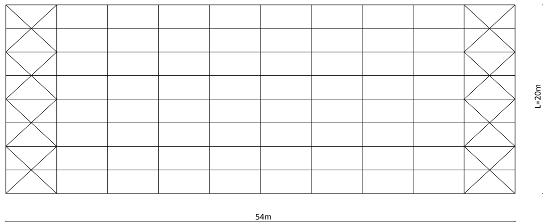
Slika 2 Tlocrtni prikaz konstrukcije
