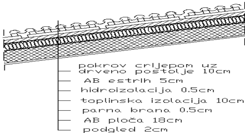
Slika 3.1. Presjek ploče poz. 200
