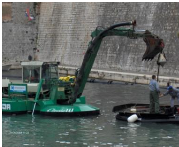
Slika.4.10. Plovno jaružalo WATERMASTER [11]
