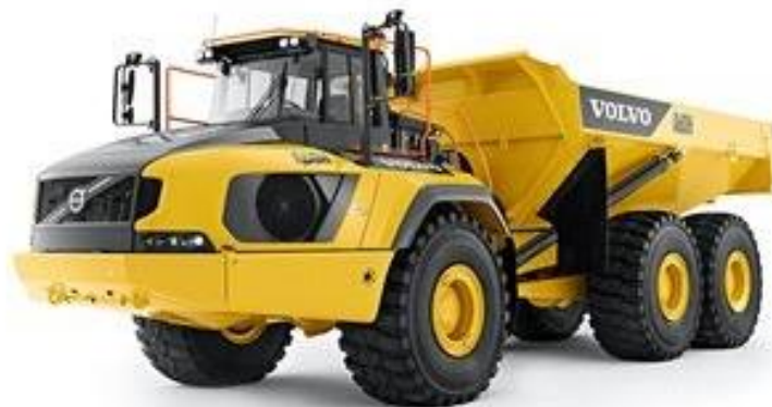
Slika 4.2. Damper VOLVO A60H [3]
