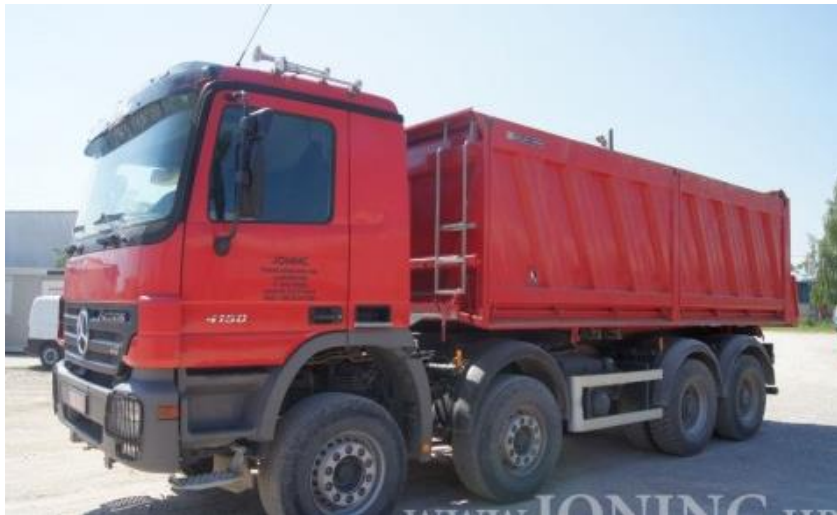
Slika 4.5. Kamion kiper MERCEDES BENZ ACTROS 4150 V8 [6]
