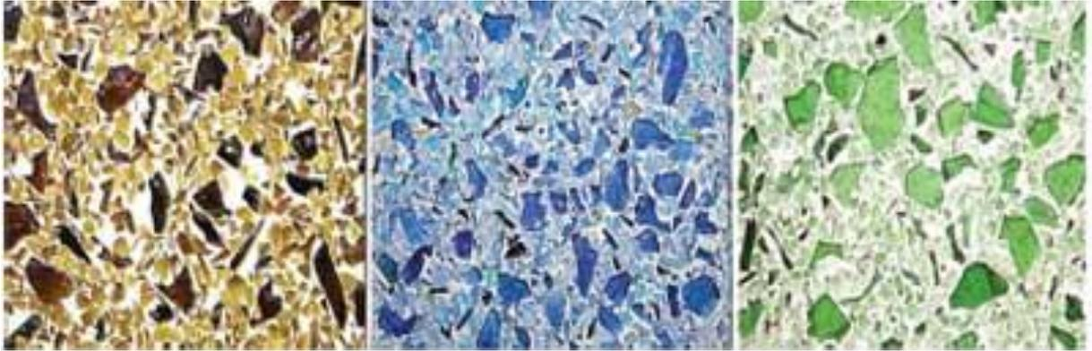
*Slika 1. Izgled betona sa različitim vrstama recikliranog stakla*
