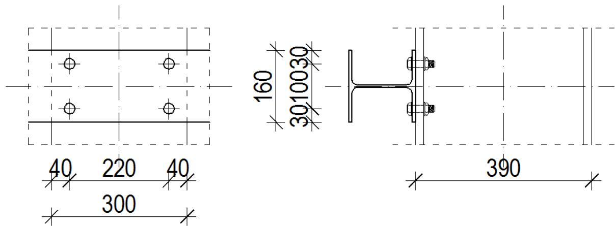
Slika 7.5.2 Spoj bočne podrožnice s glavnom konstrukcijom (stupom)
