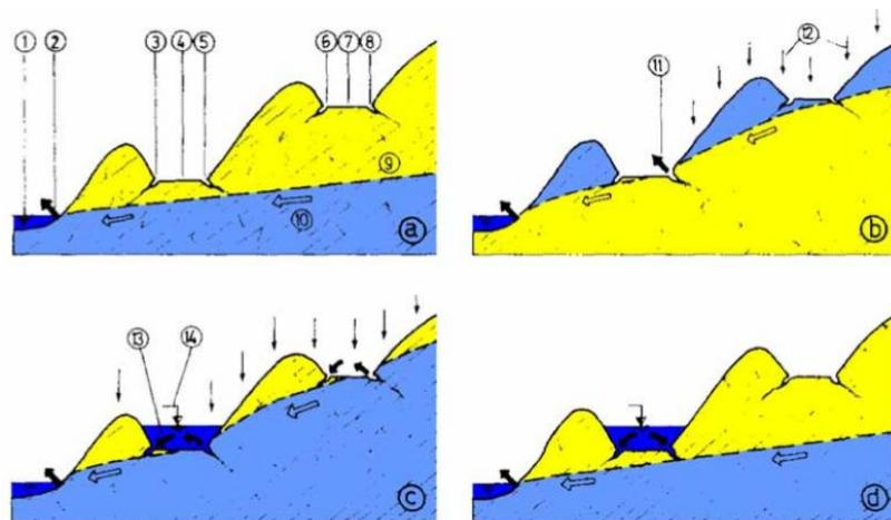
Slika 7. Princip funkciranja estavele [6]
