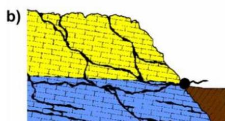
Slika 6. Vrela silaznog tipa ( a ) kontaktni, b ) barijerni ) [6]
