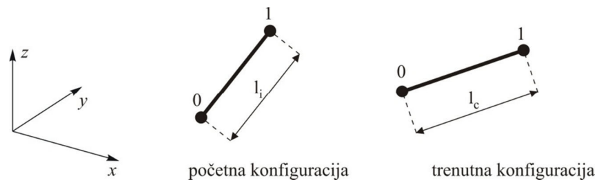
Crtež 4.2 Početna i trenutna konfiguracija dvočvornog konačnog elementa
