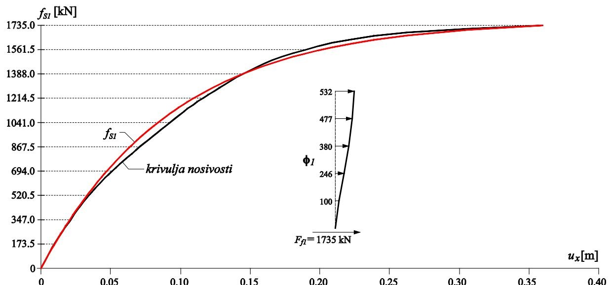
Crtež 3.9 Određivanje funkcije  $f_{SI}$  za vektor  $\phi_1$  5-katnog a/b okvira za smjer  $x$
