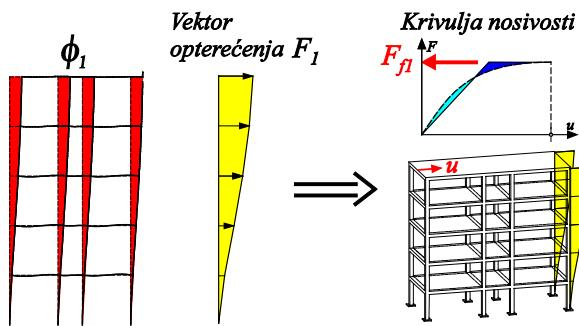
**Crtež 2.3** Određivanje krivulje nosivosti vektora  $\phi_1$  postupkom naguravanja
