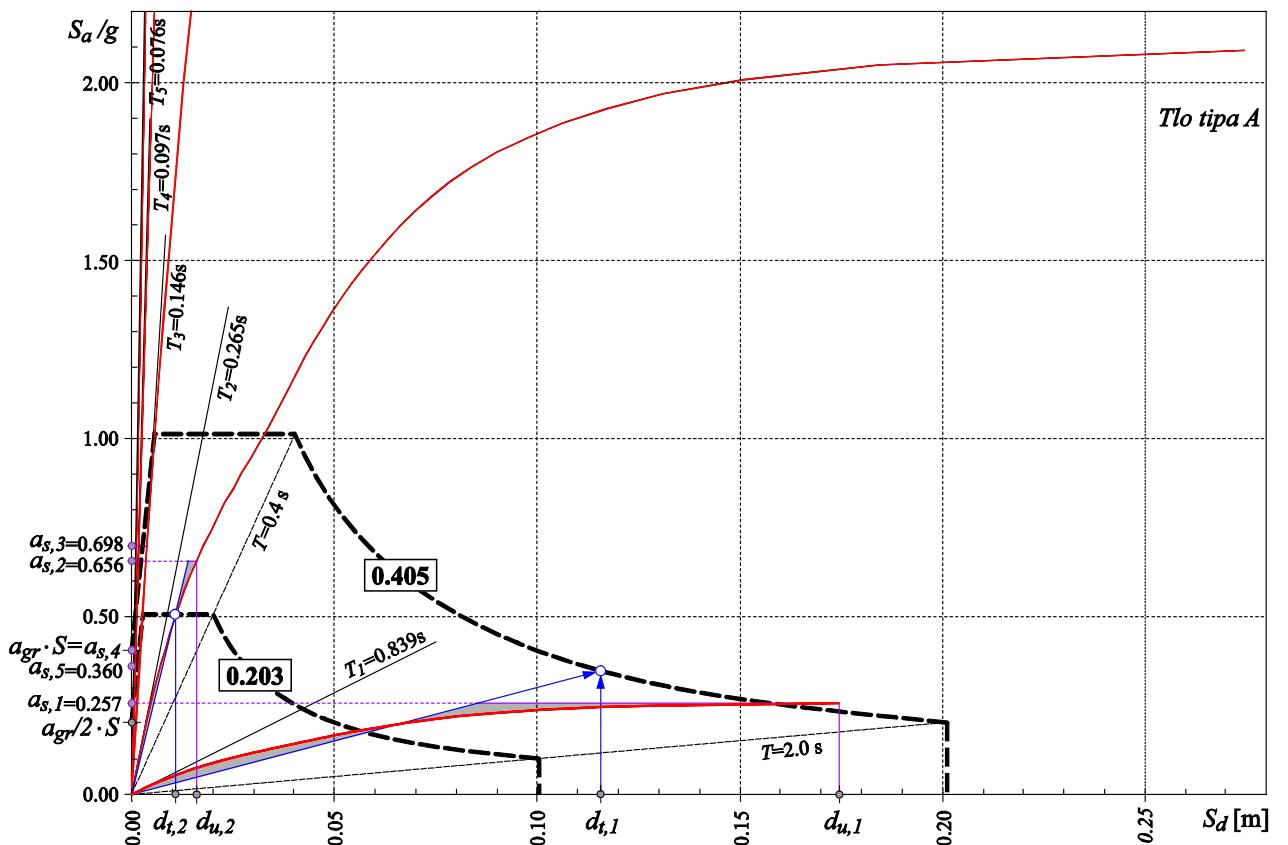
**Crtež 2.12** Određivanje spektralnog ubrzanja modova, 5-katnog a/b okvira u  $x$  smjeru, uz elastični spektar za ubrzanje tla 0.405g ( $a_{s,1}$ ) i 0.203g ( $a_{s,2}-a_{s,5}$ ), (SRSS kombinacija modova)
