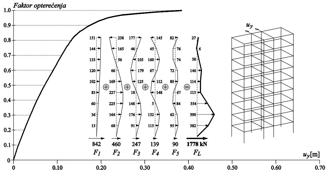
**Crtež 6.16** Krivulja nosivosti za linearnu (L) kombinaciju modova 9-katnog a/b okvira, za smjer y pri 3/3 iskoristivosti pomaka za elastični spektar s 27% prigušenjem, dobivena postupkom praktične primjene metode ciljanog ubrzanja
