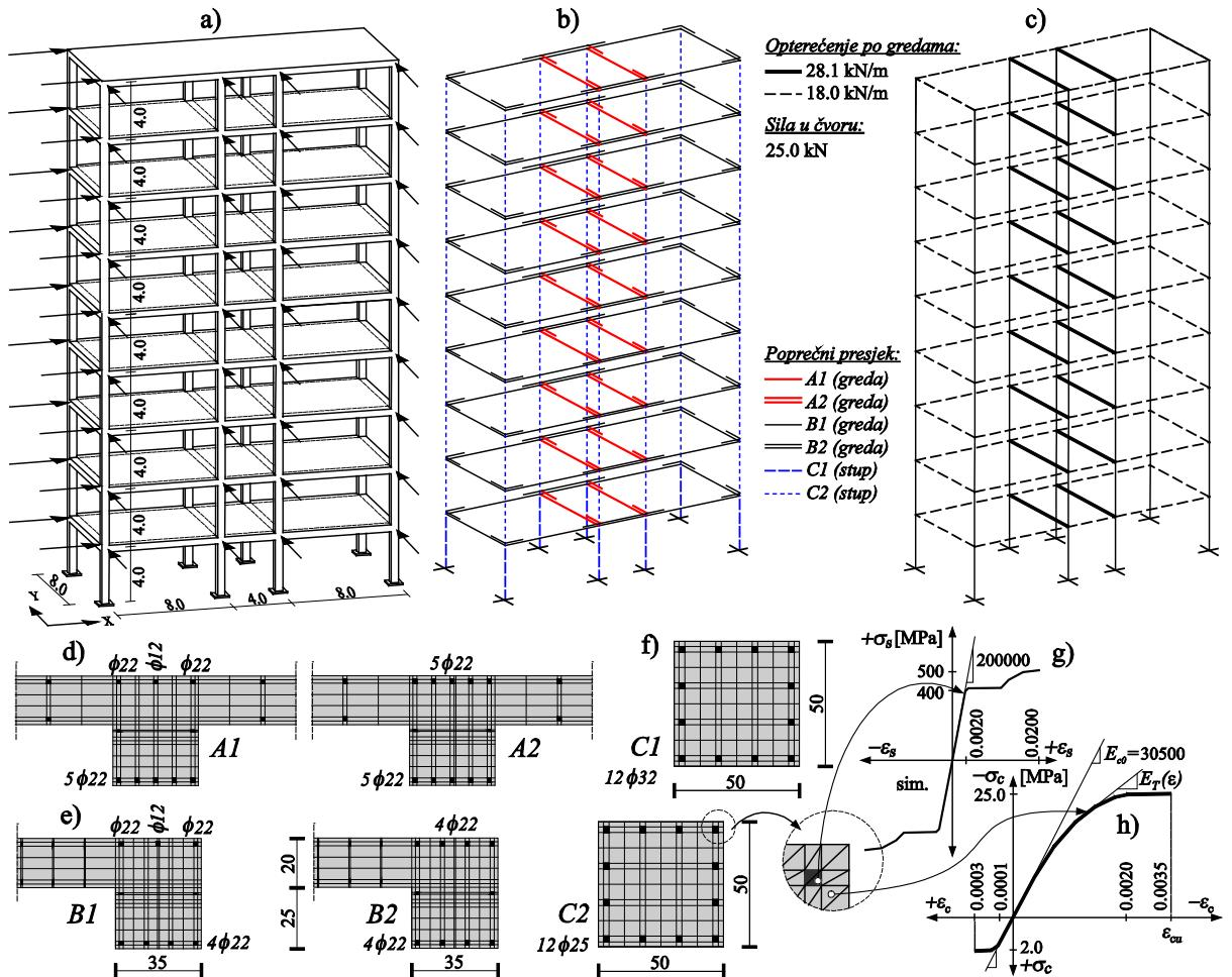
**Crtež 2.16** Primjer 2: a) prostorni 9-katni okvir; b) oznake poprečnih presjeka; c) opterećenje po gredama; d-f) diskretizacije poprečnih presjeka; g) model armaturnog čelika; h) model betona
