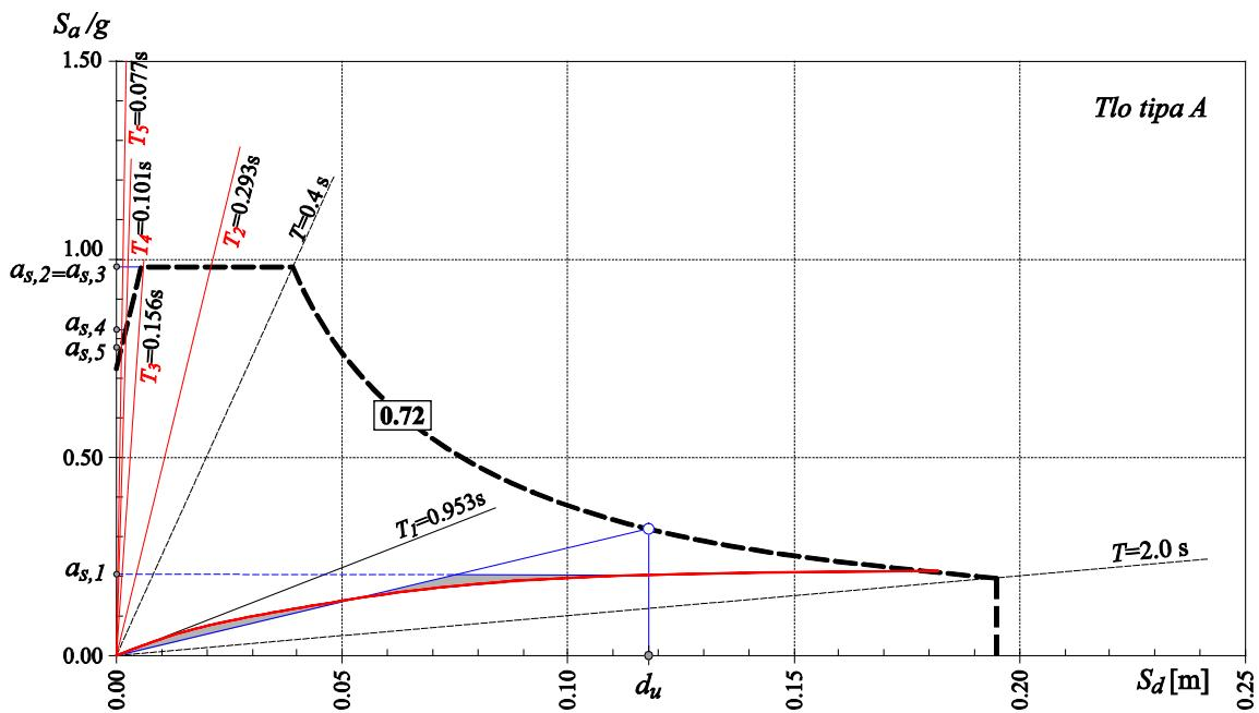
**Crtež 6.6** Određivanje spektralnog ubrzanja tla  $a_{s,i}$  promatranih vektora pri 3/3 iskoristivosti pomaka  $d_u$  uz elastični spektar s izračunatim 29% prigušenjem na primjeru 5-katnog a/b okvira za smjer y
