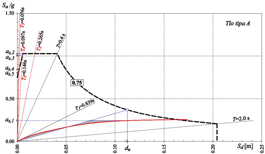
**Crtež 6.2** Određivanje spektralnog ubrzanja tla  $a_{s,i}$  promatranih vektora pri 3/3 iskoristivosti pomaka  $d_u$  uz elastični spektar s izračunatim 28% prigušenjem na primjeru 5-katnog a/b okvira za smjer x
