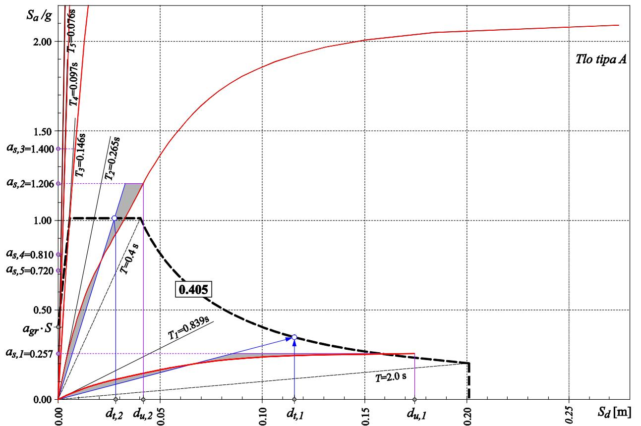
**Crtež 2.10** Određivanje spektralnog ubrzanja modova, 5-katnog a/b okvira u  $x$  smjeru, uz elastični spektar za ubrzanje tla 0.405g (L kombinacija modova)
