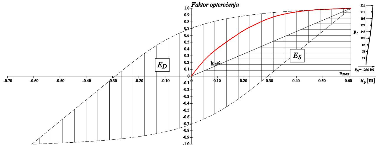
**Crtež 4.12** Određivanje utrošene energije u jednom ciklusu osciliranja nelinearnog i linearног sustava 9-katnog a/b okvira (smjer y)
