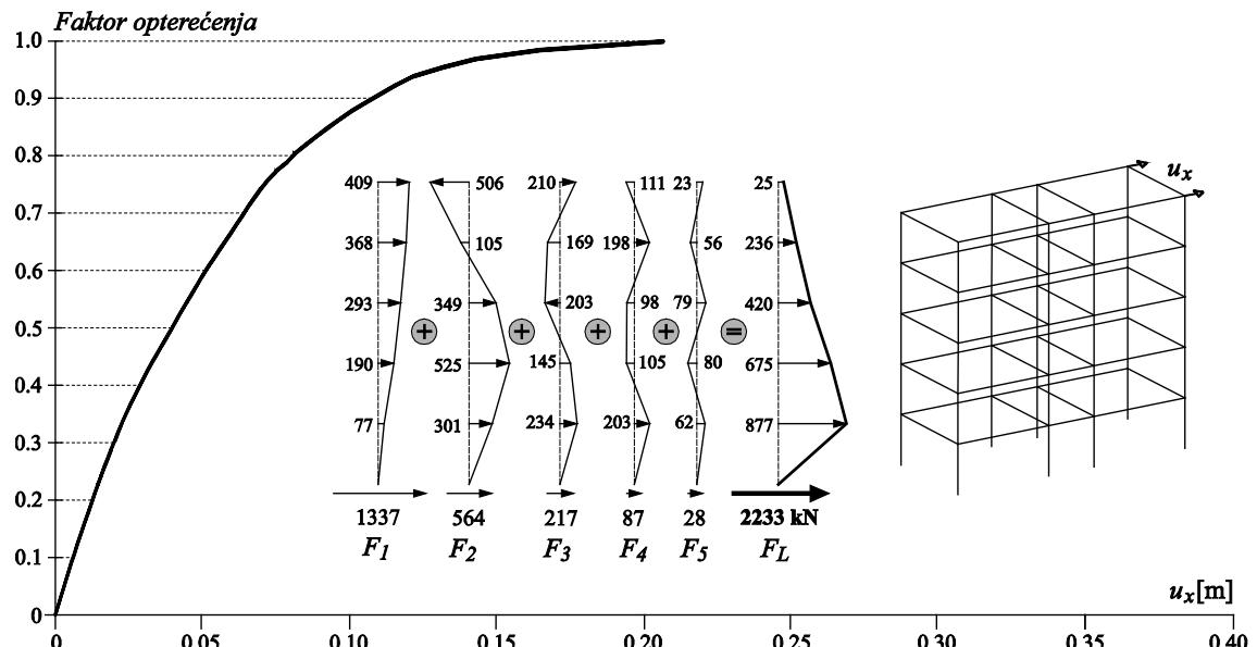
**Crtež 6.4** Krivulja nosivosti za linearnu (L) kombinaciju modova 5-katnog a/b okvira, za smjer x pri 3/3 iskoristivosti pomaka uz elastični spektar s 28% prigušenjem, dobivena postupkom praktične primjene metode ciljanog ubrzanja
