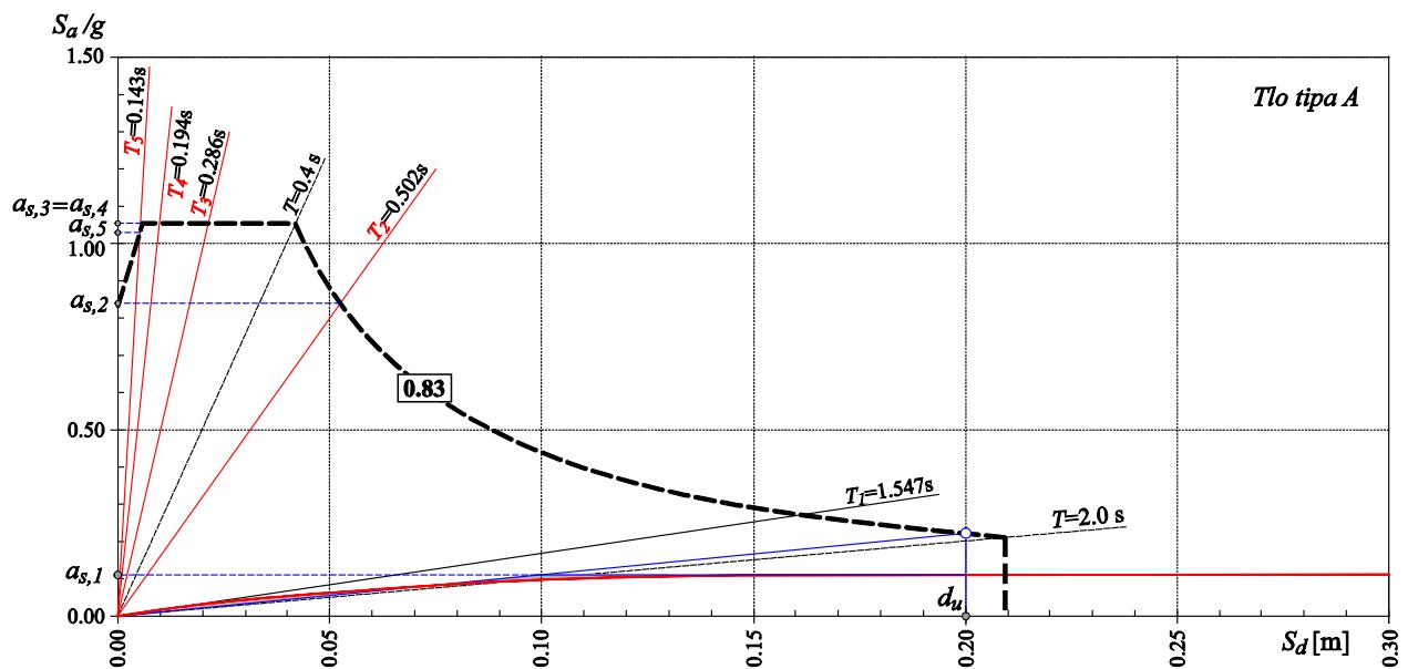
**Crtež 6.10** Određivanje spektralnog ubrzavanja tla  $a_{s,i}$  promatranih vektora pri 3/3 iskoristivosti pomaka  $d_u$  uz elastični spektar s izračunatim 34% prigušenjem na primjeru 9-katnog a/b okvira za smjer x
