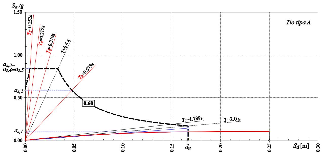
**Crtež 6.14** Određivanje spektralnog ubrzanja tla  $a_{s,i}$  promatranih vektora pri 3/3 iskoristivosti pomaka  $d_u$  uz elastični spektar s izračunatim 27% prigušenjem na primjeru 9-katnog a/b okvira za smjer y
