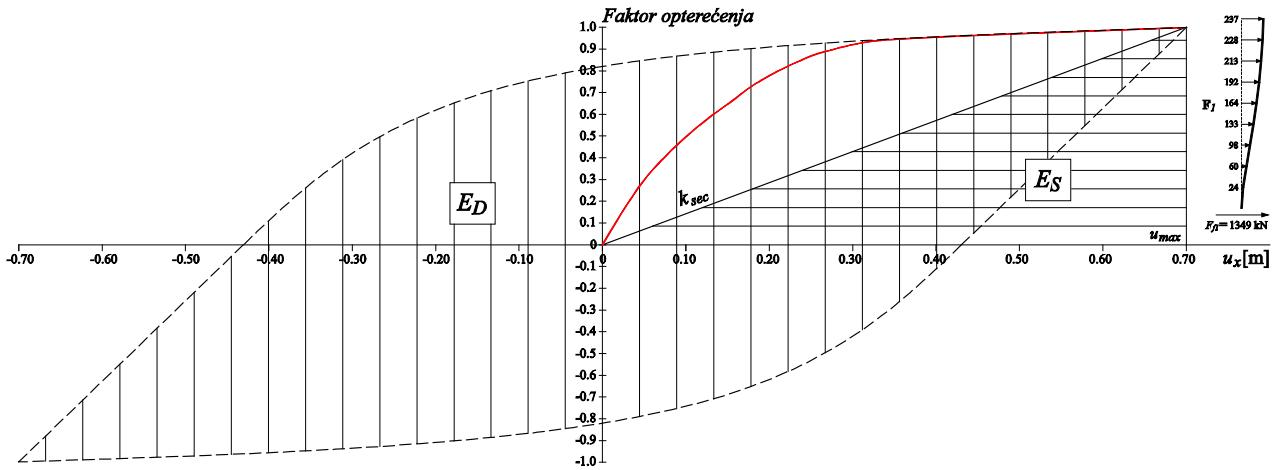
**Crtež 4.9** Određivanje utrošene energije u jednom ciklusu osciliranja nelinearnog i linearne sustava 9-katnog a/b okvira (smjer x)
