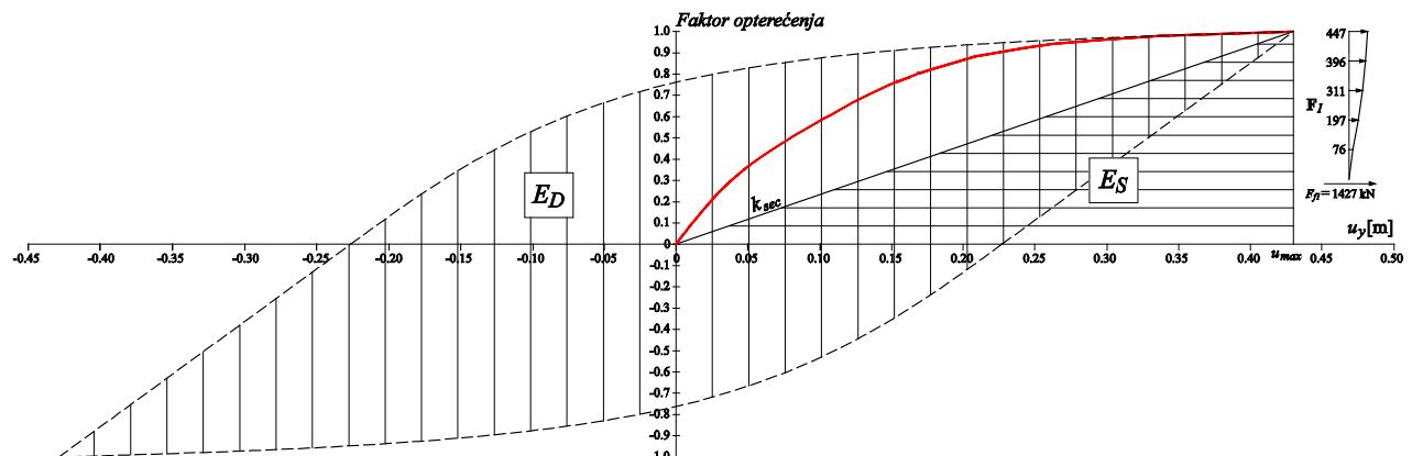
**Crtež 4.6** Određivanje utrošene energije u jednom ciklusu osciliranja nelinearnog i linearног sustava 5-katnog a/b okvira (smjer y)
