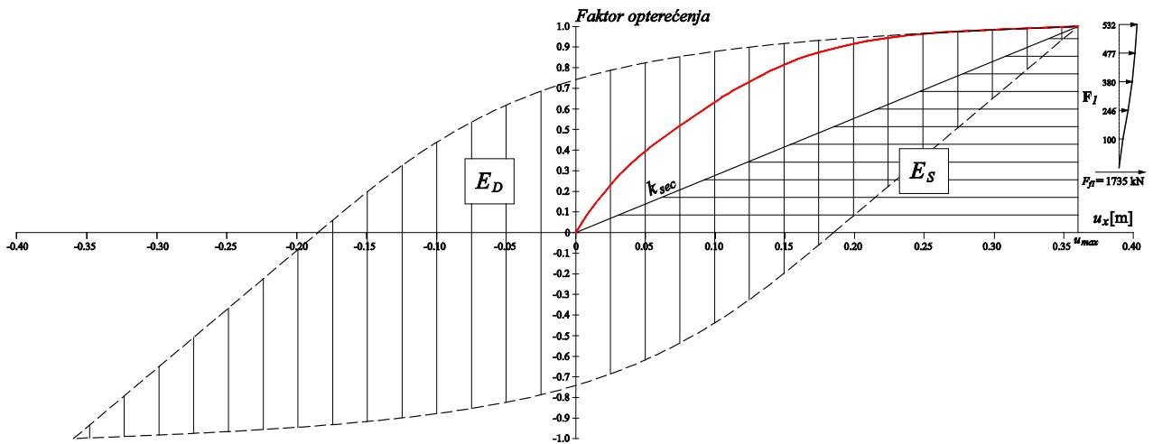
**Crtež 4.3** Određivanje utrošene energije u jednom ciklusu osciliranja nelinearnog i linearne sustava 5-katnog a/b okvira (smjer x)
