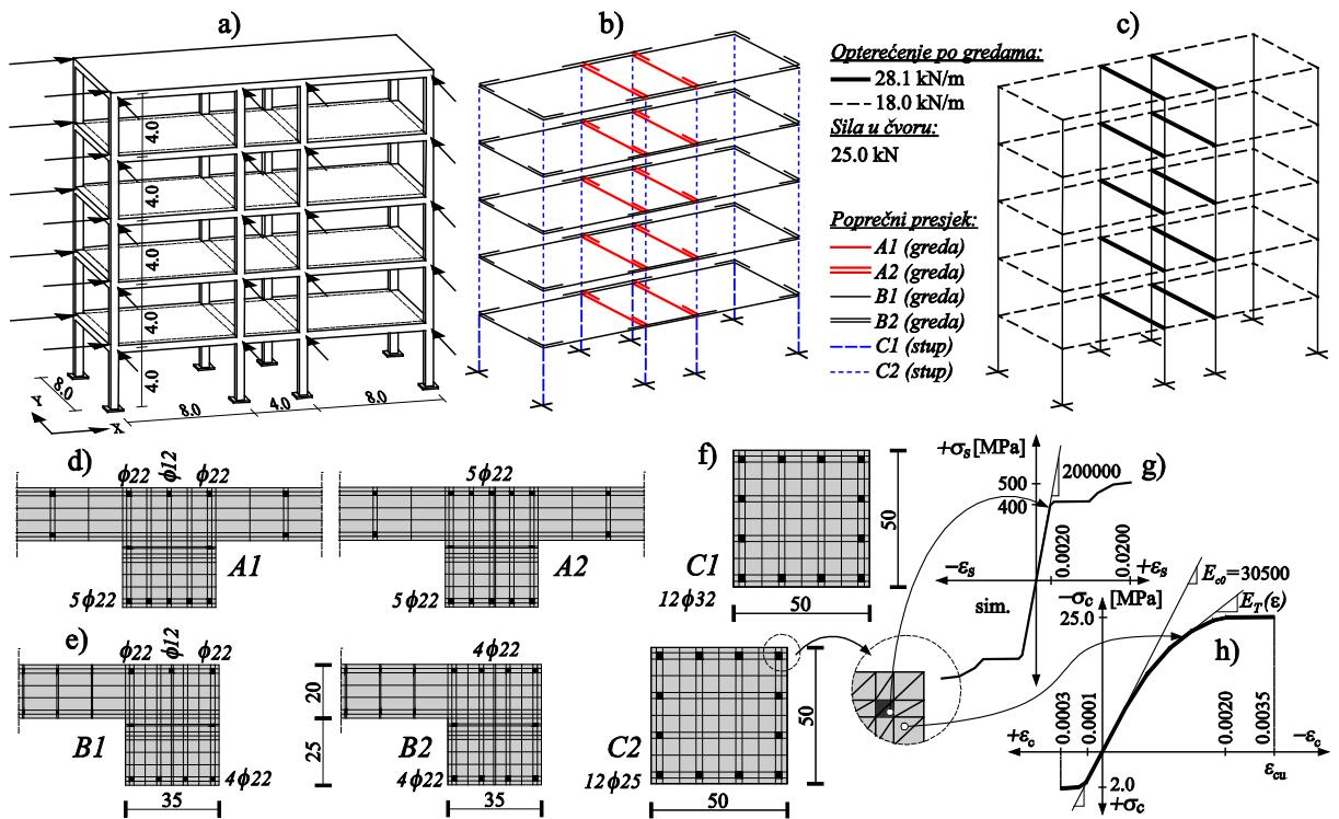
**Crtež 2.7** Primjer 1: **a)** prostorni 5-katni okvir; **b)** oznake poprečnih presjeka; **c)** opterećenje po gredama; **d)-f)** diskretizacije poprečnih presjeka; **g)** model armaturnog čelika; **h)** model betona
