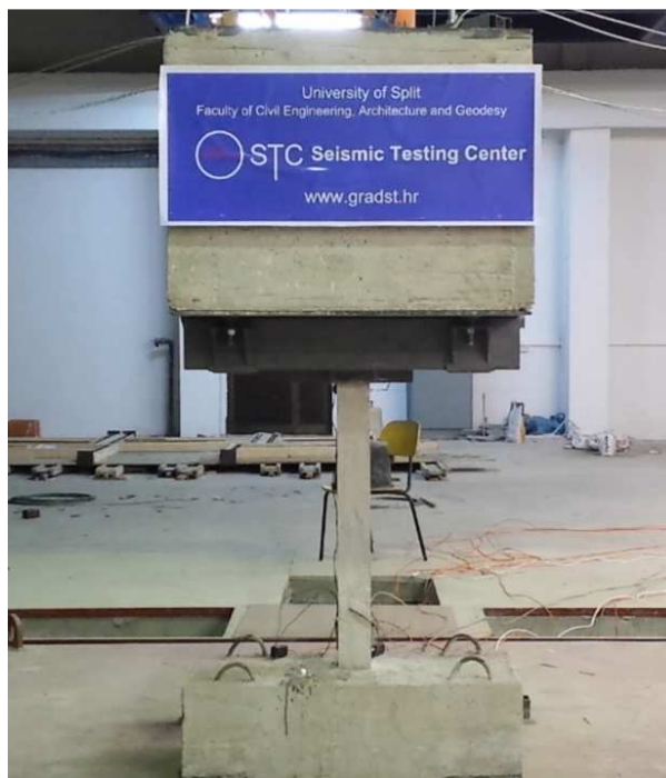
Slika 3.49 Izgled karakterističnog stupa prije ispitivanja
