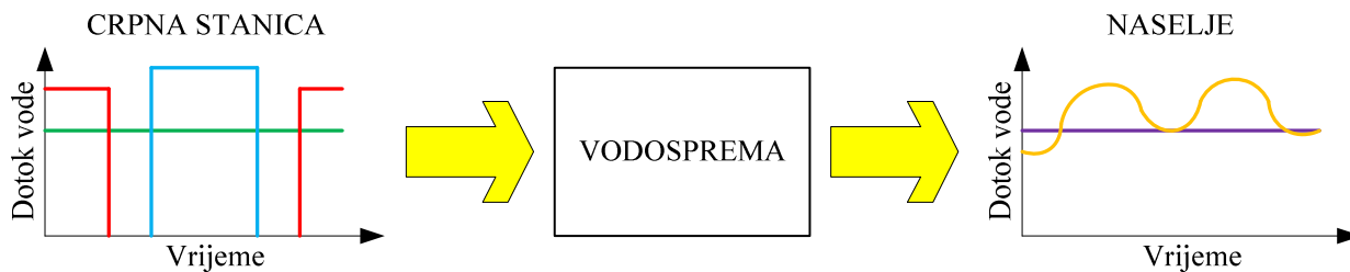
Slika 4.7. Shematski prikaz režima ulaza i izlaza vode iz vodospreme
