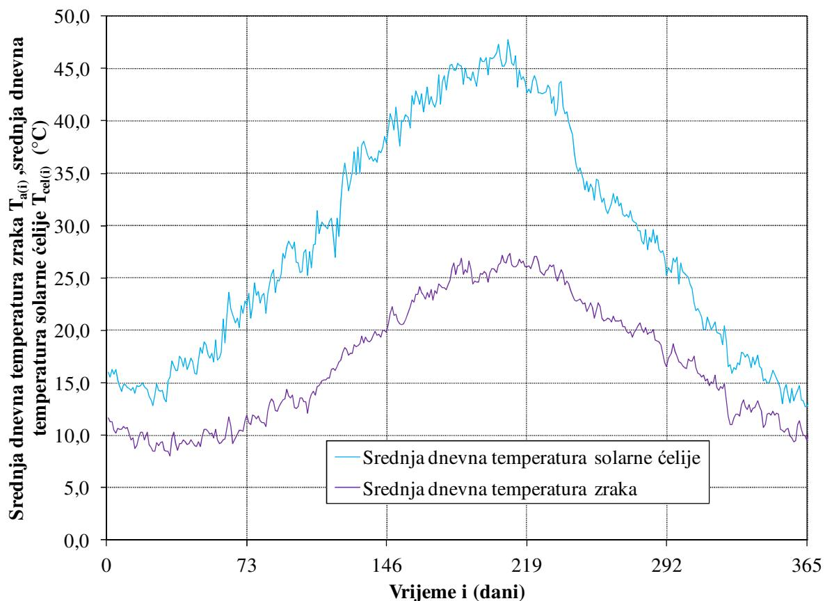
Slika 6.5. Prosječna dnevna temperatura zraka i solarne čelije, [D5]
