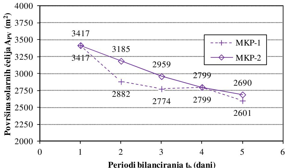
Slika 6.10. Proračunate površine solarnih čelija  $A_{PV}$  za oba načina formiranja vremenskih serija, MKP-1 i MKP-2, za periode bilanciranja  $t_b$  od 1 do 5 dana
