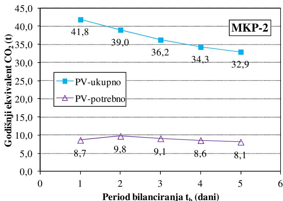
Slika 6.24. Proračunate godišnje ekvivalentne količine CO<sub>2</sub> koje proizvodi podsustav PV za ukupno proizvedenu i za ukupno potrebnu količinu električne energije
