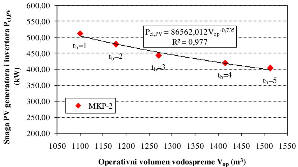
Slika 6.12. Funkcionalna zavisnost snage PV generatora i invertora  $P_{el,PV}$  i operativnog volumena vodospreme  $V_{op}$  za MKP-2
