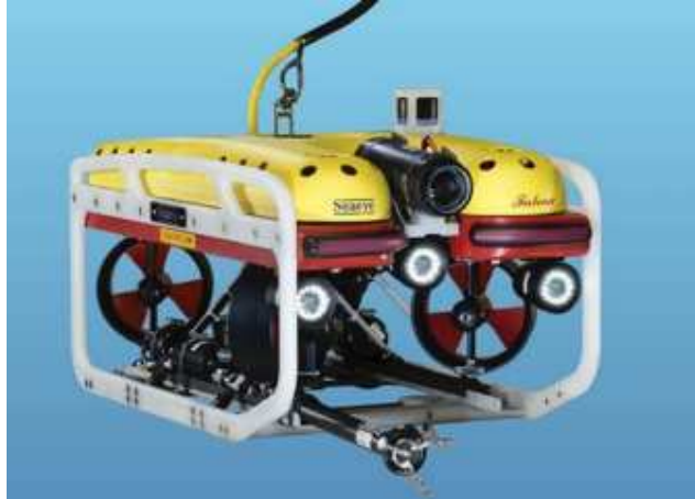
Slika 5.36 ROV ronilica SEAEYE FALCON korištena za profiliranje dna Crvenog jezera.
