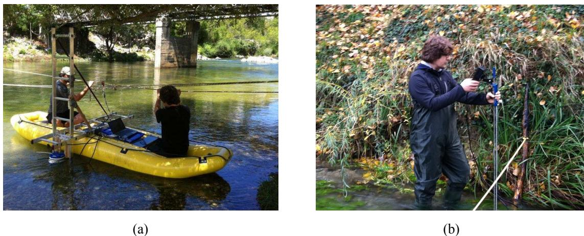
**Slika 1.5** Mjerjenje protoka ADCPom a) i ADVom b) na otvorenom vodotoku
