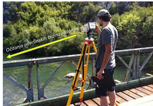
**Slika 1.6** Mjerenje površinske brzine vodotoka radarskim uređajem
