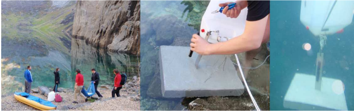
Slika 5.23 Instaliranje CTD divera na dno jezera (06.11.2009.) na dno Modrog jezera.
