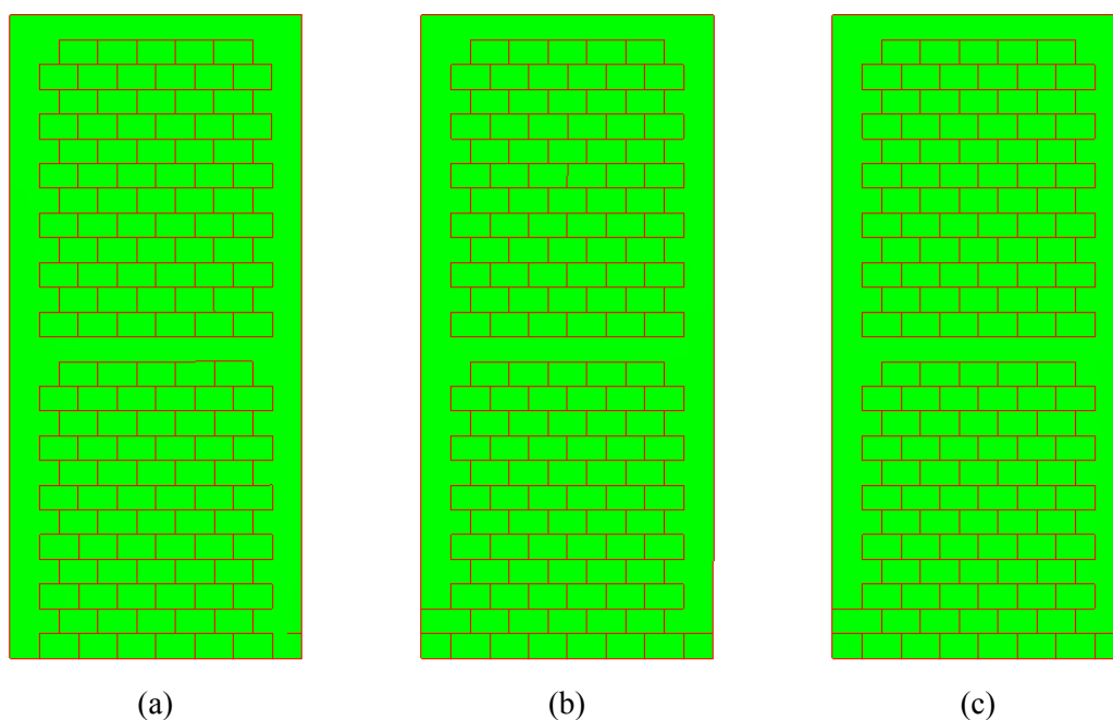
Crtež 6.28 Nastanak i širenje pukotina za vršno ubrzanje a=3.0 \text{ m/s}^2 u vremenu: (a) t=1.977 \text{ s} ; (b) t=7.125 \text{ s} ; (c) t=12.00 \text{ s}
