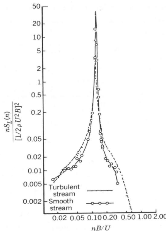
**Slika 3.10** Spektar odgovora za kvadratni poprečni presjek u jednolikom i turbulentnom polju fluida. Posebno opasan za konstrukcije je slučaj sinkroniziranja frekvencije oscilacije sile dinamičkog uzgona s vlastitom frekvencijom konstrukcije. Tada dolazi do fenomena zvanog *lock-in* uslijed kojeg dolazi do velikih pomaka.
