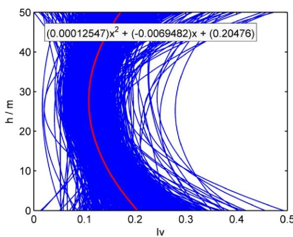
**Slika 5.13** Promjena intenziteta turbulencije po visini a) za jugo, b) za buru
