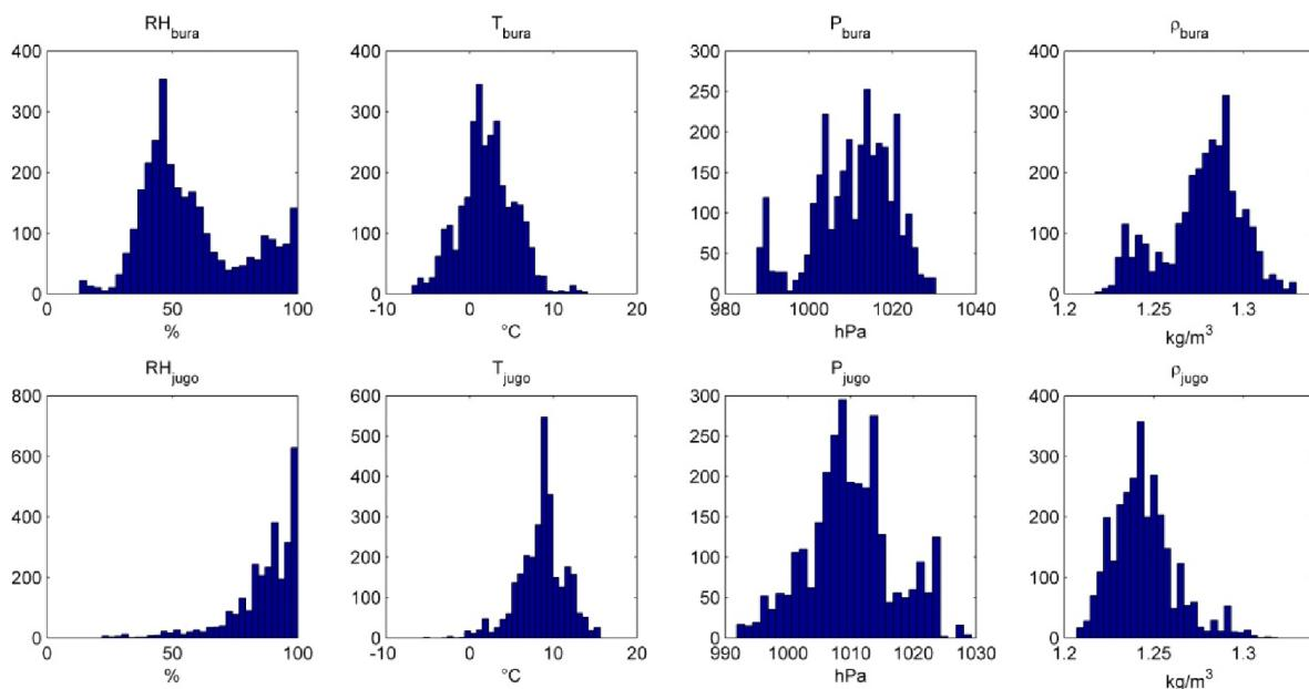
**Slika 5.21** Razdioba atmosferskih parametara za buru i jugo
