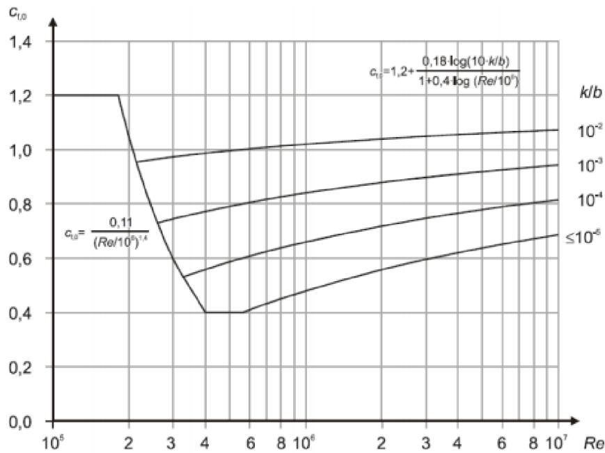
Slika 3.21 Osnovni koeficijent oblika za kružne valjke
