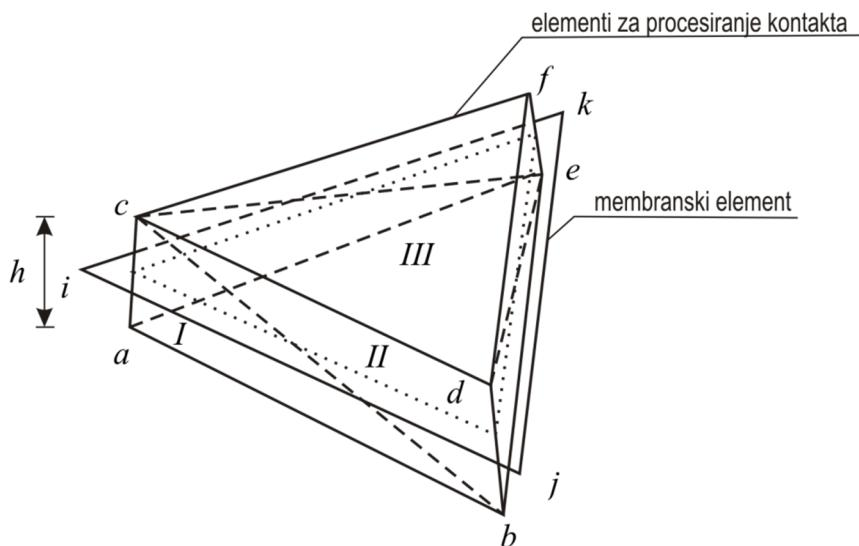
**Slika 7.5** Membranski element i elementi za procesiranje kontakta
