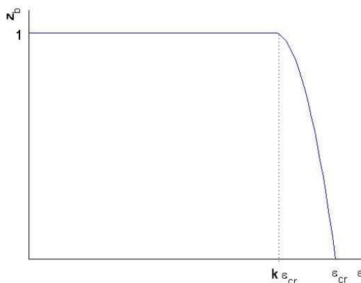
**Slika 6.5** Smanjenje naprezanja u elementu uslijed izvijanja
