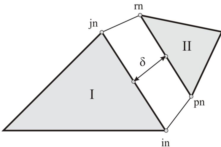
**Slika 7. 4** Kontaktni element
