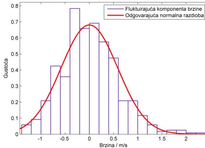
**Slika 5.11** Histogram fluktuirajuće komponente i pripadajuća normalna razdioba
