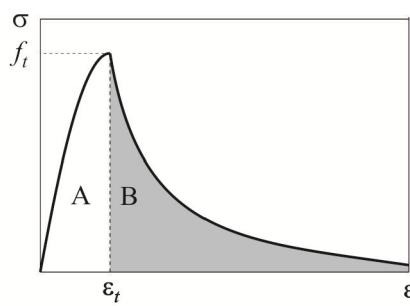
Slika 4.5 Vlačno omekšanje prikazano u relaciji naprezanje – deformacija
