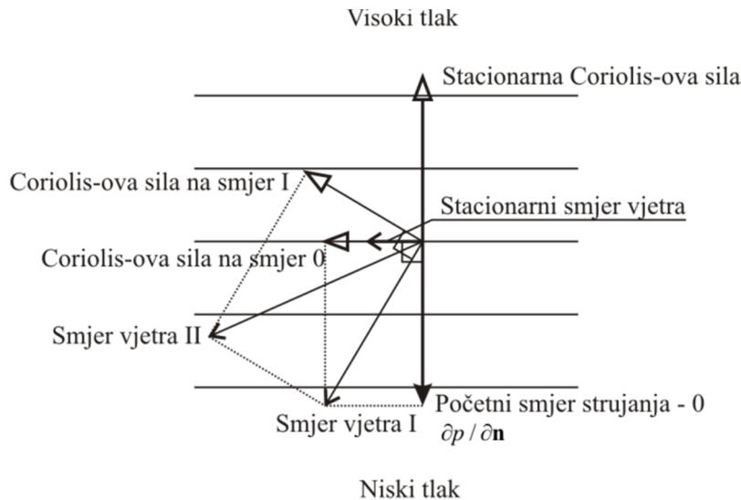
**Slika 3.2** Postupak balansiranja gradijenta tlaka i Coriolisove sile
