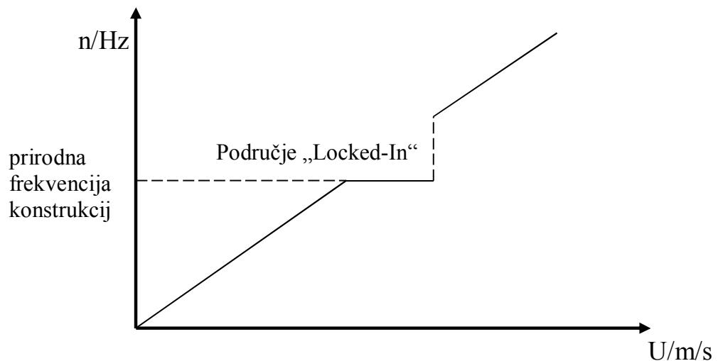
**Slika 3.13** Frekvencija odbacivanja vrtloga i srednja brzina toka
