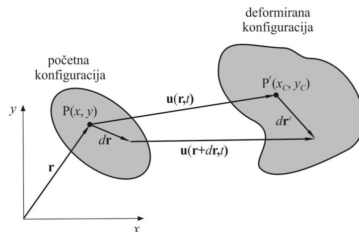
Slika 4.1 Deformabilno tijelo u početnoj i deformiranoj konfiguraciji
