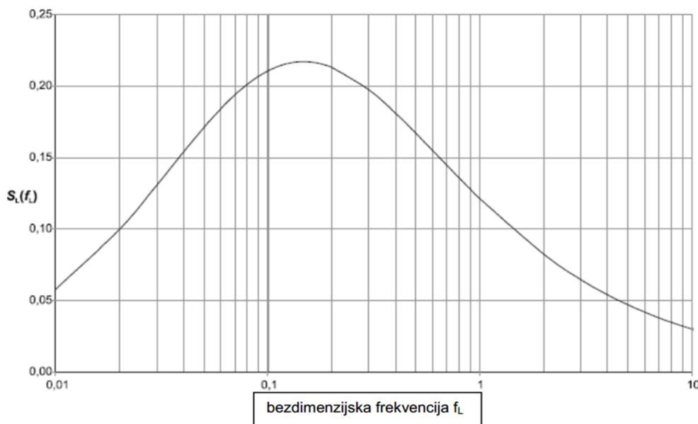
**Slika 3. 19** Funkcija spektralne gustoće snage,  $S_L(f_L)$
