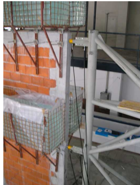
Slika 3.10. Prikaz položaja hidrauličkih preša
