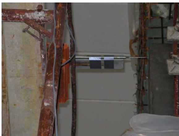
*Slika 3.7.* Prikaz mjerjenja horizontalnog pomaka vrha omeđenog zida senzorom pomaka
