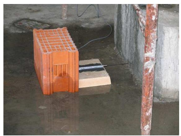
*Slika 3.8.* Prikaz mjerjenja vertikalnog pomaka temelja (odizanje) omeđenog zida senzorom pomaka
