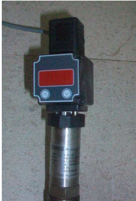
Slika 3.9. Senzor tlaka (manometar) za mjerenje sile
