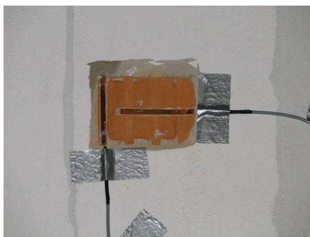
*Slika 3.12.* Prikaz zalipljene mjerne trake na ziđe
