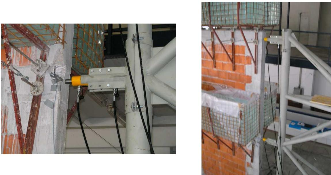
**Slika 3.10.** Prikaz položaja hidrauličkih preša
