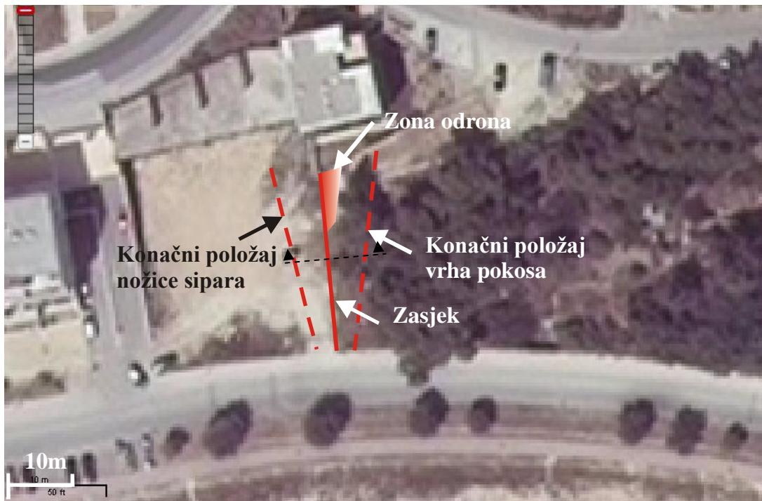
Slika 5.12. Situacija i položaj zasječka na pilot lokaciji „Žnjan 1“. (Crvena linija - zasječek; crvena isprekidana linija - procjenjeni konačni oblik zasječka prema Fisher–Lehmannu; crna isprekidana linija - karakteristični poprečni presjek)
