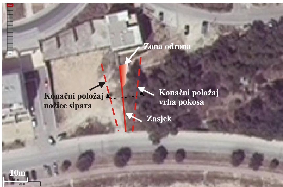
Slika 5.12. Situacija i položaj zasjeka na pilot lokaciji „Žnjan 1“. (Crvena linija - zasjek; crvena isprekidana linija - procjenjeni konačni oblik zasjeka prema Fisher–Lehmannu; crna isprekidana linija - karakteristični poprečni presjek)
