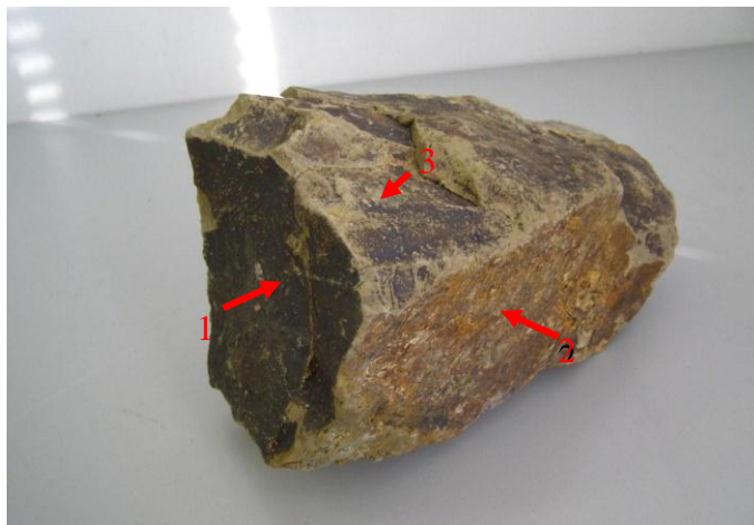
Slika 3.17. Uzorak s tri međusobno gotovo okomita pukotinska sustava (1. i 3. - sekundarne pukotine; 2. - međuslojna pukotina). Na sekundarnim pukotinama uočava se tamno smeđa skrama.
