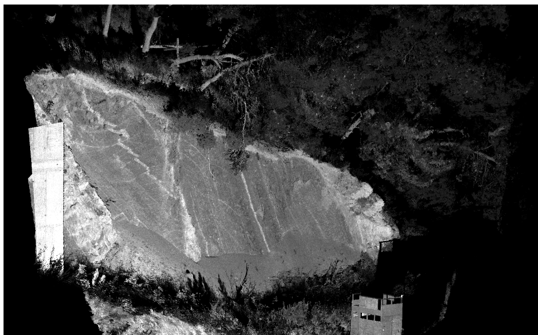
Slika 5.10. Primjer oblaka točkica s približno 4 milijuna točkica (Pilot lokacija „Žnjan 1“)
