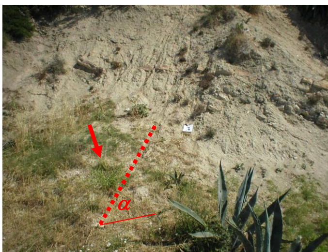
Slika 3.18. Izmjereni nagib pokosa deponiranog rastrošenog lapora na dnu kosina (strelica), u rasponu \alpha = 31^\circ do 38^\circ
