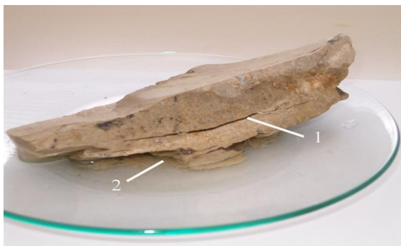
Slika 2.4. Primjer raspadanja lapora s područja Dalmacije: 1 - raspucavanje, 2 - ljuštenje [104]
