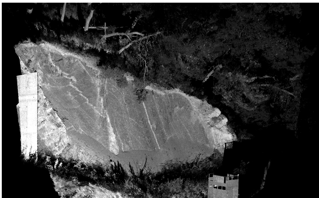
Slika 5.10. Primjer oblaka točkaca s približno 4 milijuna točkaca (Pilot lokacija „Žnjan 1“)
